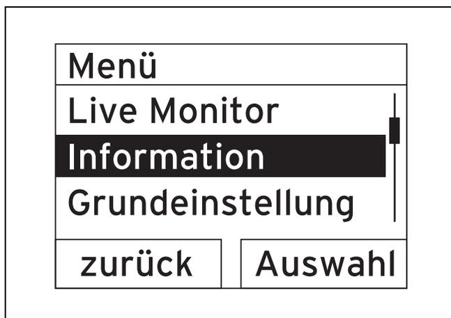
Ein markiertes Objekt wird Ihnen im Display durch Inversdarstellung (helle Schrift auf dunklem Grund) angezeigt.
