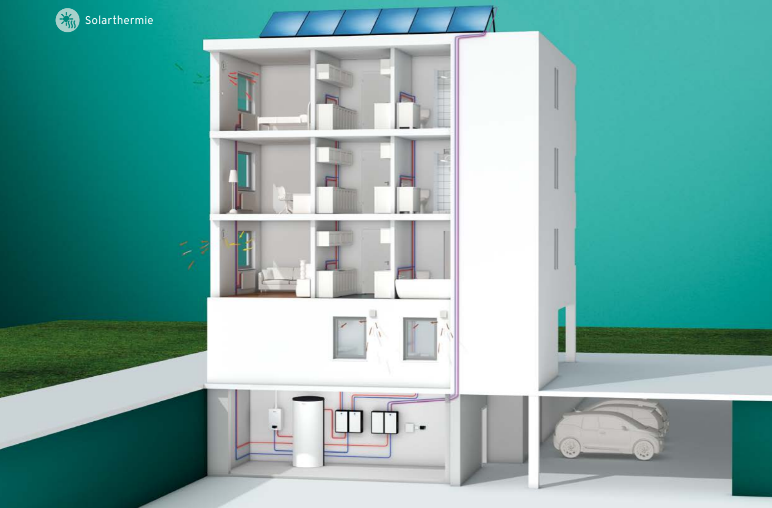
Solarsystem auroTHERM mit zentralem Gas-Brennwertsystem ecoTEC plus VC 1-5
