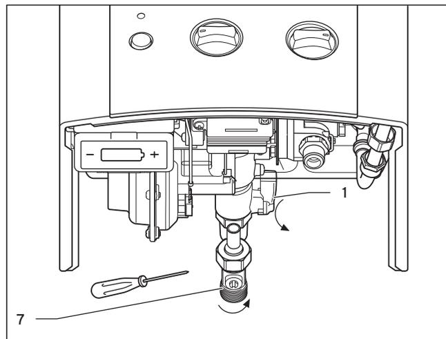
Abb. 4.2 Absperrrichtungen
