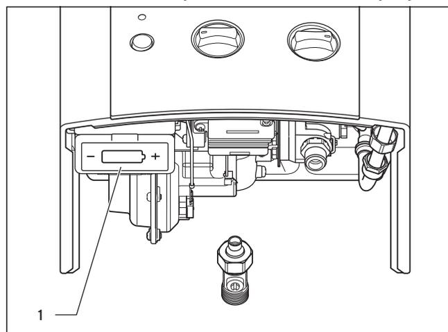
Fig. 4.8 Batteriewechsel
