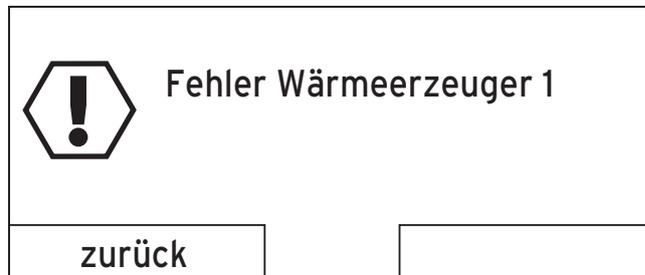
Wenn der Regler anstatt der Grundanzeige eine Fehlermeldung im Display anzeigt und Sie die linke Funktionstaste **zurück** drücken, dann erscheint wieder die Grundanzeige im Display.
