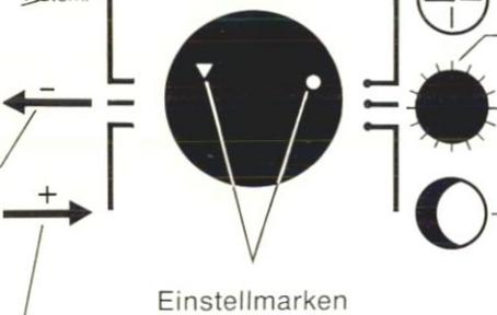
Heizungsregelung arbeitet entsprechend Uhrzeit und Einstellung der Schaltuhr (s. Seite 6) **automatisch wechselnd** im „normalen“ bzw. im Heizbetrieb mit Temperaturabsenkung.
