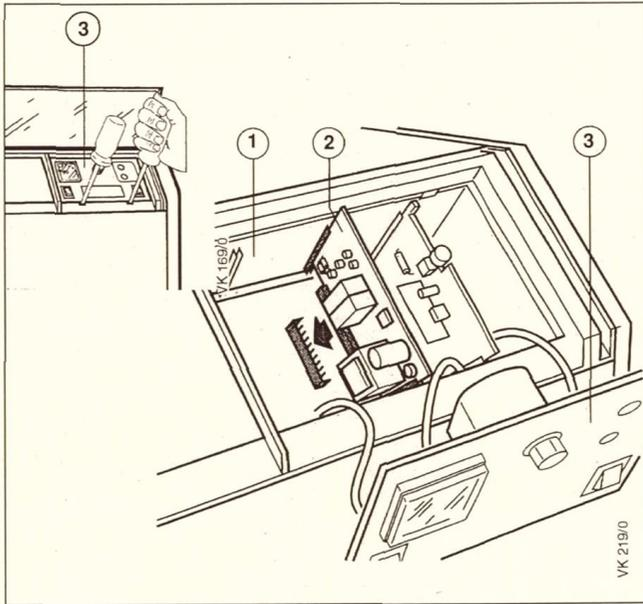
Die Bedienblende (3) wie in der Abbildung gezeigt aus der Schaltleiste (1) heraus hebeln.
