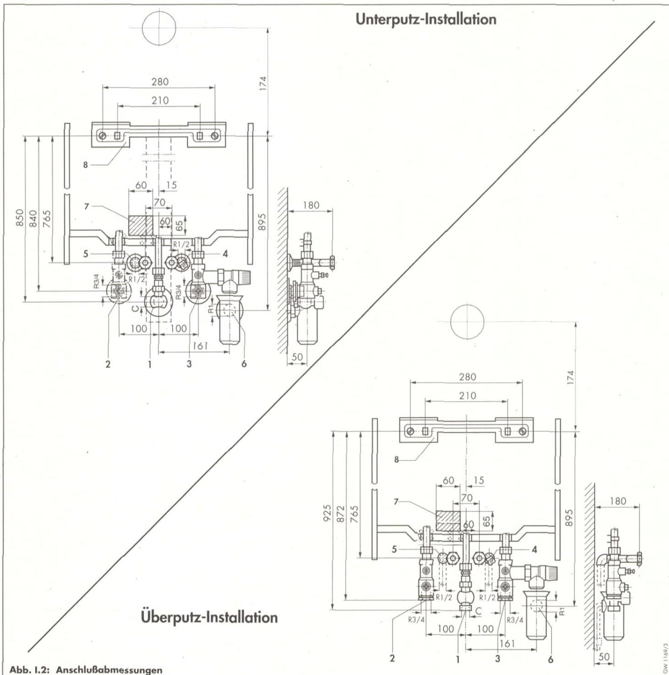
Abb. I.2: Anschlußabmessungen
