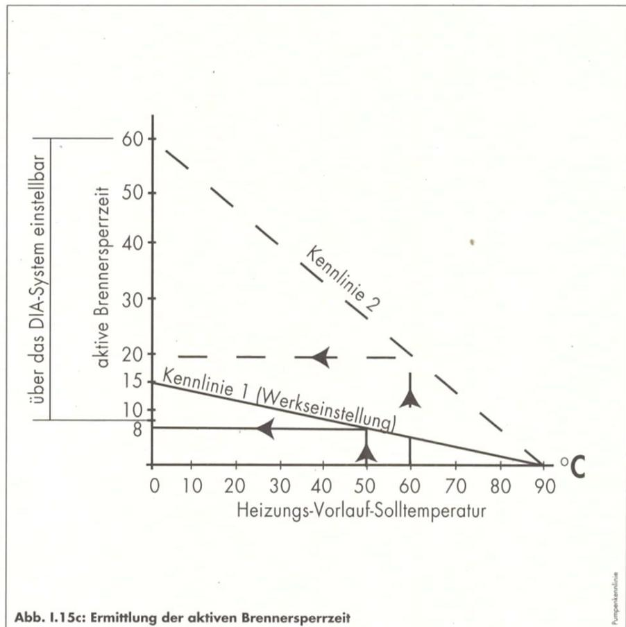
Abb. I.15c: Ermittlung der aktiven Brennersperrzeit
