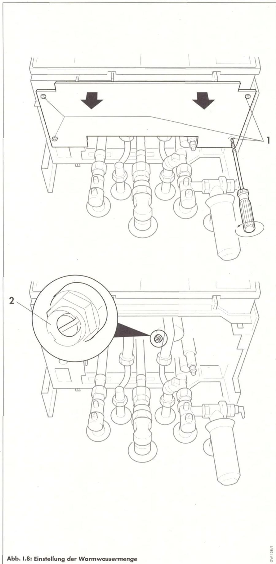
Abb. I.8: Einstellung der Warmwassermenge
