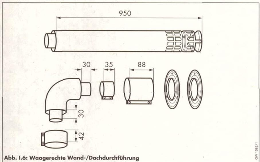
Abb. 1.6: Waagerechte Wand-/Dachdurchführung
