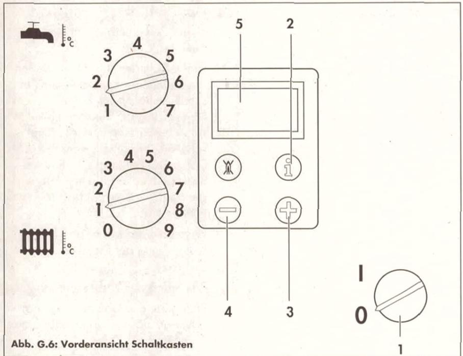
Abb. G.6: Vorderansicht Schaltkasten
