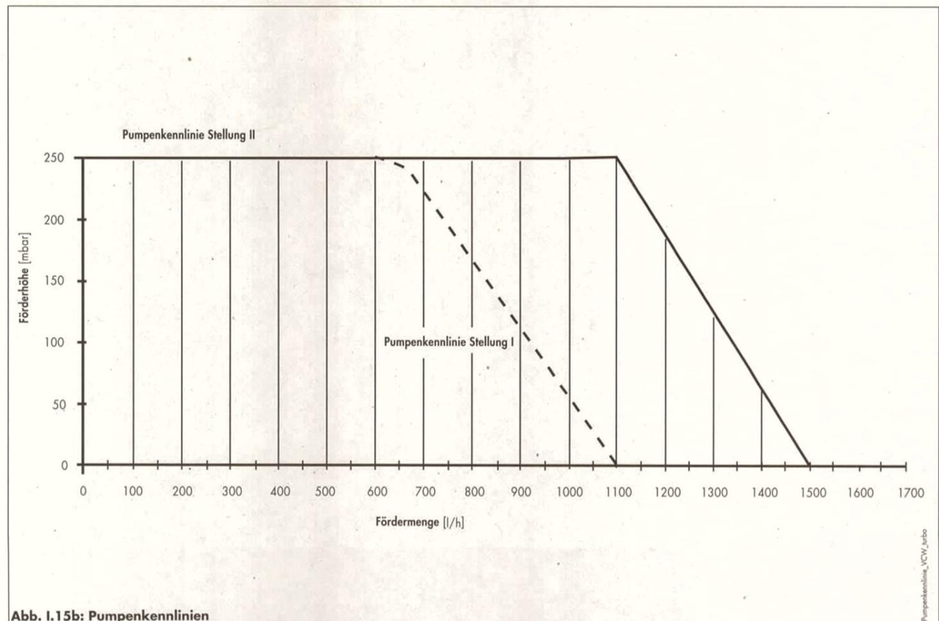
Abb. I.15b: Pumpenkennlinien
