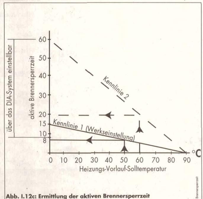
Abb. I.12c: Ermittlung der aktiven Brennersperrzeit
