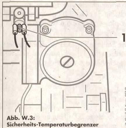
Spricht bei einer Störung der Temperaturbegrenzer an, so geht das Gerät außer Betrieb (Anzeige im Display „F 20“).
