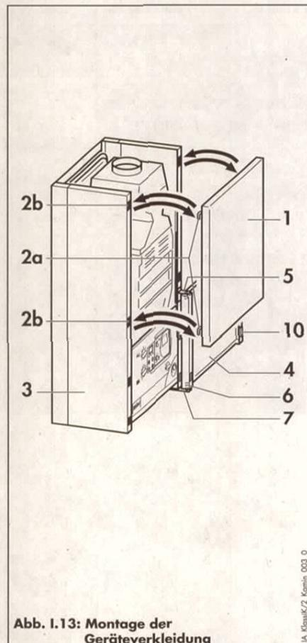
Abb. I.13: Montage der Geräteverkleidung
