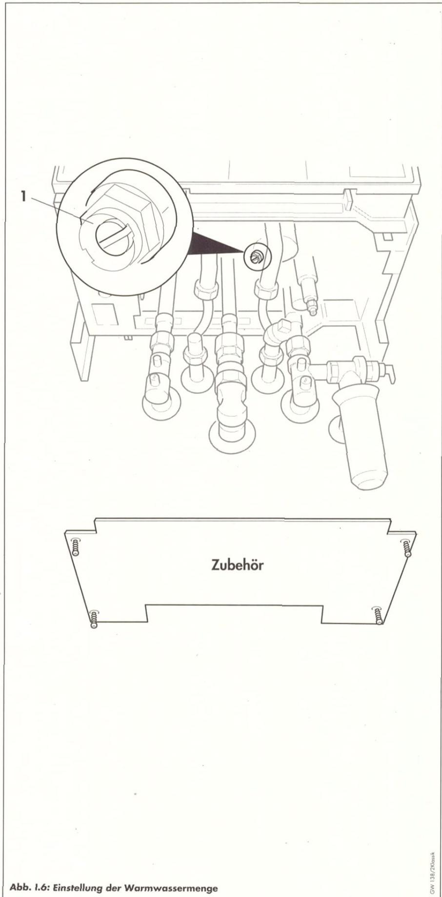
Abb. 1.6: Einstellung der Warmwassermenge
