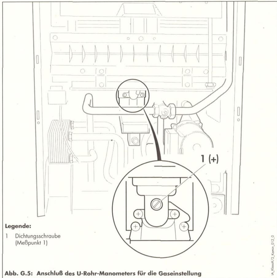
Abb. G.5: Anschluß des U-Rohr-Manometers für die Gaseinstellung
