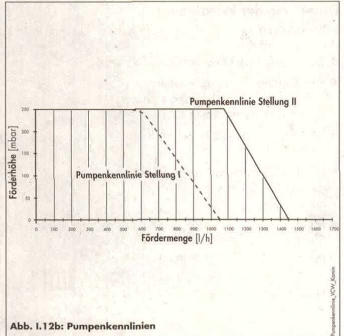
Abb. I.12b: Pumpenkennlinien
