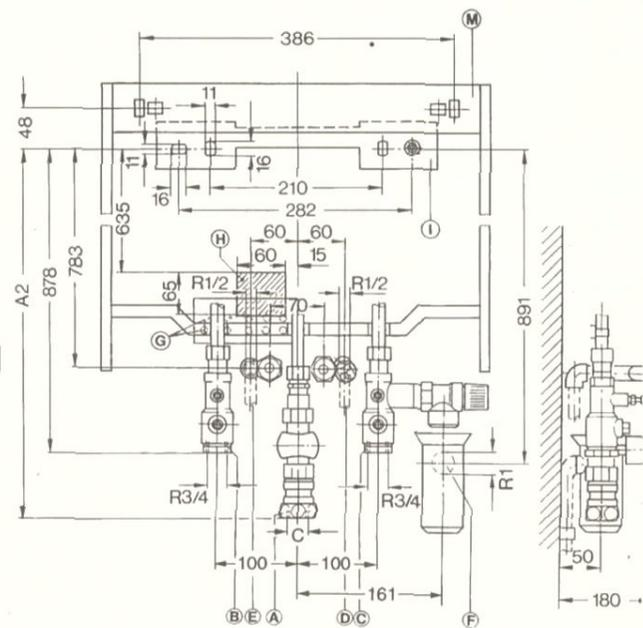
Abb. I.2: Anschlußabmessungen
