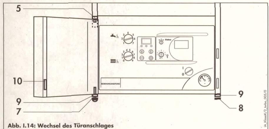
Abb. I.14: Wechsel des Türanschlages
