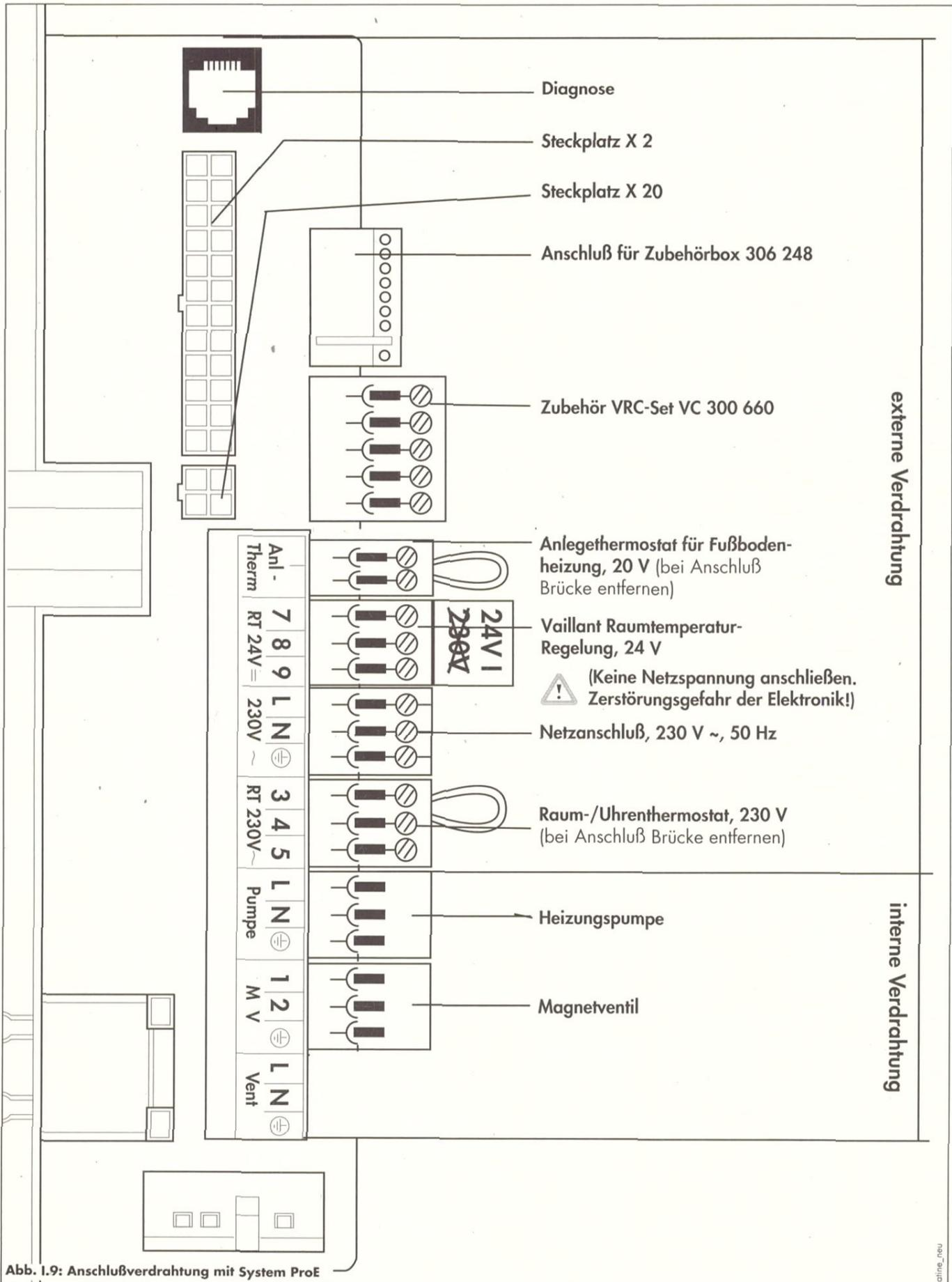
Abb. I.9: Anschlußverdrahtung mit System ProE
