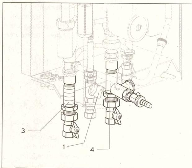
Abb. 3.5 Absperreinrichtungen öffnen (VC 466)
