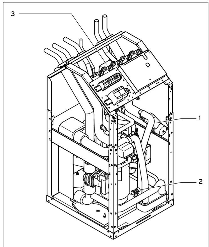
**6.1 Umschaltventile und Füll- und Entleerungsventil des Heizkreises**
