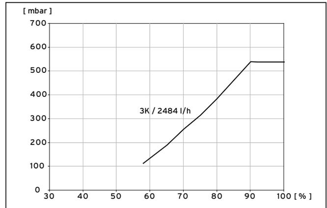
9.3 Diagramm Leistungsoptimierung Solepumpe VWS 104/3
