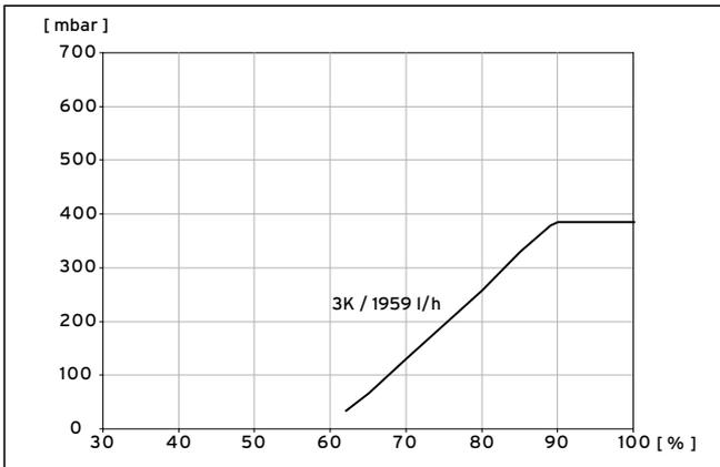
9.2 Diagramm Leistungsoptimierung Solepumpe VWS 84/3
