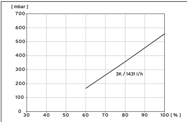
9.1 Diagramm Leistungsoptimierung Solepumpe VWS 64/3
