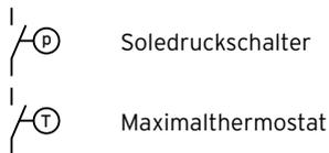
In einigen Fällen, z. B. in Trinkwasserschutzgebieten, schreiben örtliche Behörden die Installation eines externen Soledruckschalters vor, der den Kältekreis abschaltet, wenn ein bestimmter Druck im Solekreis unterschritten wird.
