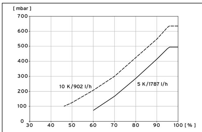
**9.6 Diagramm Leistungsoptimierung Heizkreispumpe VWS 104/3**
