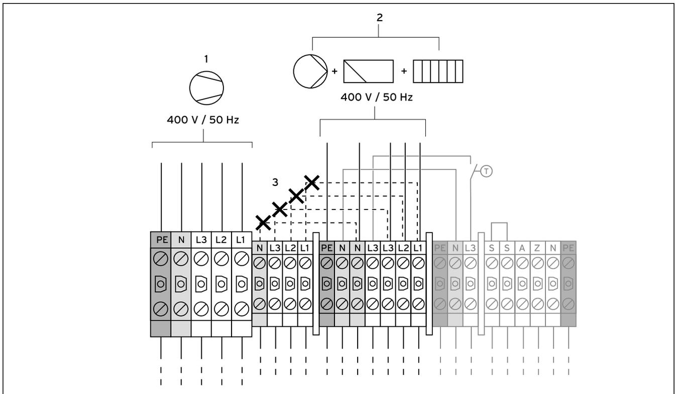
**7.5 Zweikreis-Einspeisung Wärmepumpen-Tarif**
