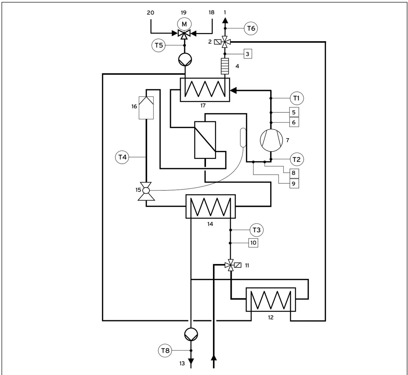
17.1 Wärmepumpenschema VWS ..4/3
