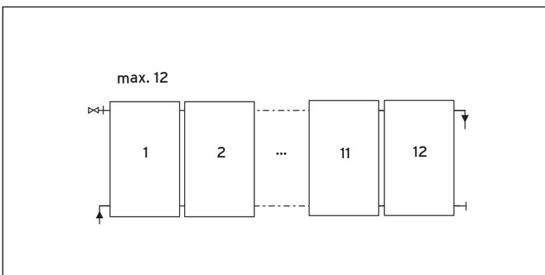
**Abb. 4.3 Reihenschaltung 6 - 12 Flachkollektoren**
