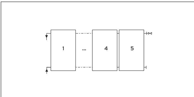
**Abb. 4.2 Reihenschaltung 1 - 5 Flachkollektoren**
