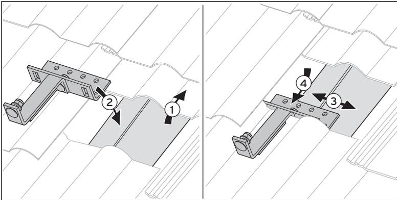
Abb. 5.6 Position des Dachankers Typ P auf dem Dachsparren festlegen
