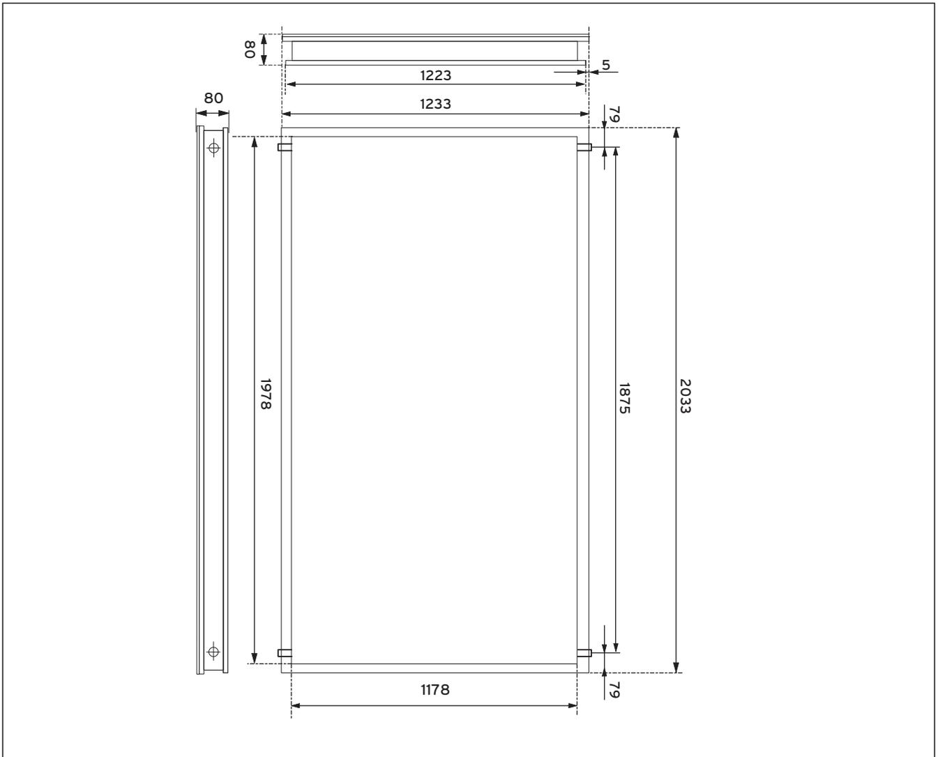
Abb. 12.1 Maßzeichnung VFK 125/3, VFK 145/2 V, VFK 155 V
