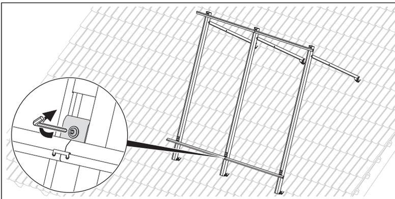
Abb. 5.19 Montageleisten unten befestigen
