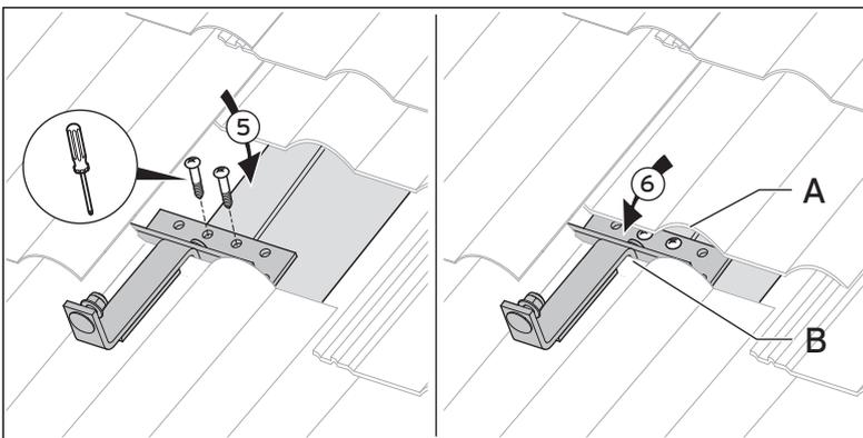
Abb. 5.7 Dachanker Typ P auf dem Dachsparren befestigen
