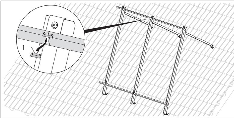
Abb. 5.18 Montageleisten verbinden (mit Sicherungsklammer)
