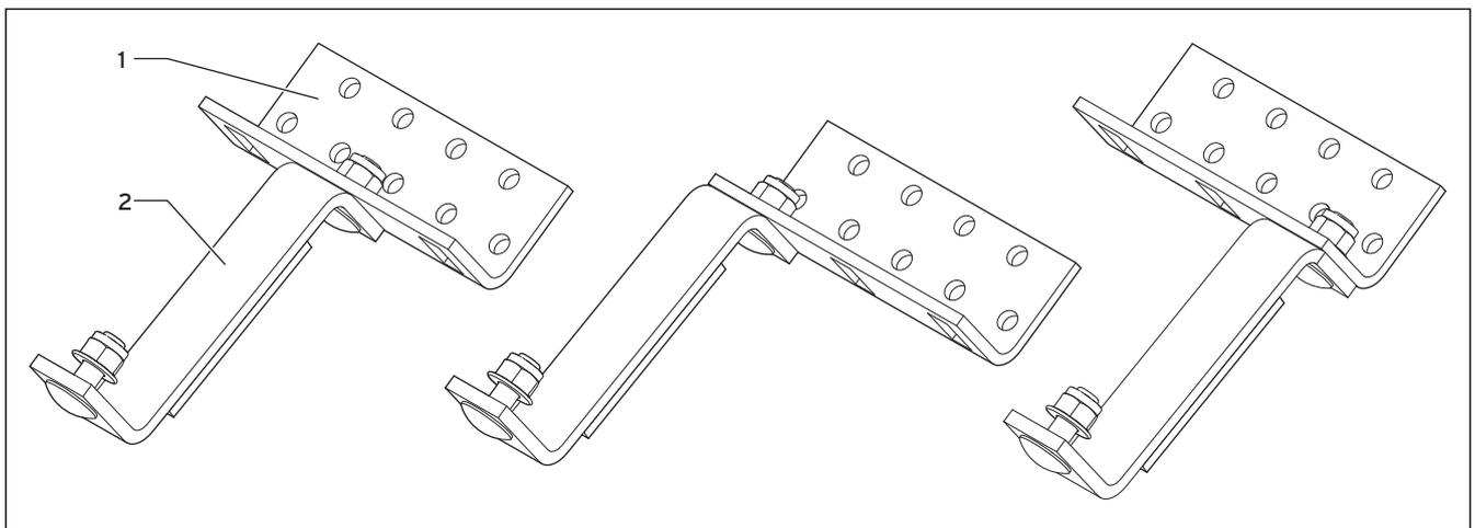
**Abb. 5.5 Dachanker Typ P**
