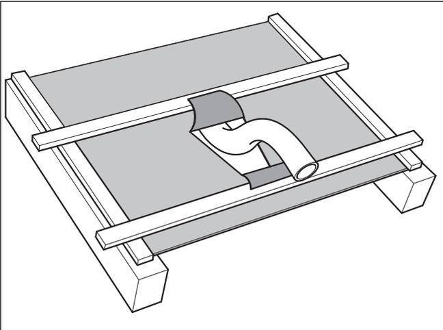
**Abb. 5.2 Rohr durch Unterspannbahn oder Dachpappe führen**
