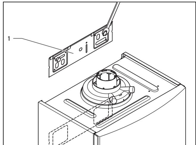
1. Montieren Sie den Gerätehalter (1) an der Wand.
