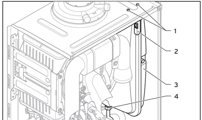
2. Lösen Sie die Verschraubung **(4)**.
