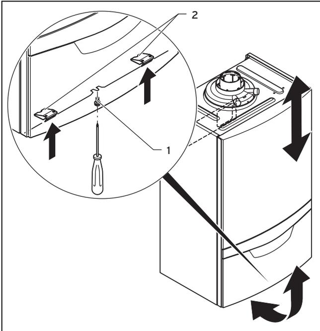
1. Lösen Sie die Schraube (1).
