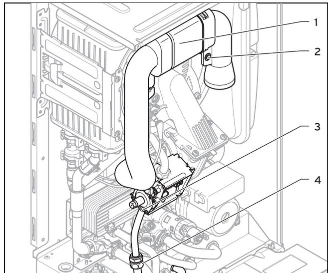
5. Drehen Sie die Halteschraube **(2)** heraus und nehmen Sie das Luftansaugrohr **(1)** vom Ansaugstutzen ab.
