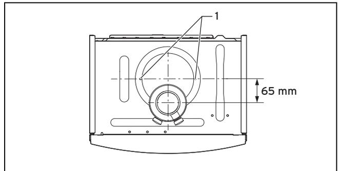
2. Setzen Sie das alternative Anschlussstück mit Versatz nach vorn ein.
