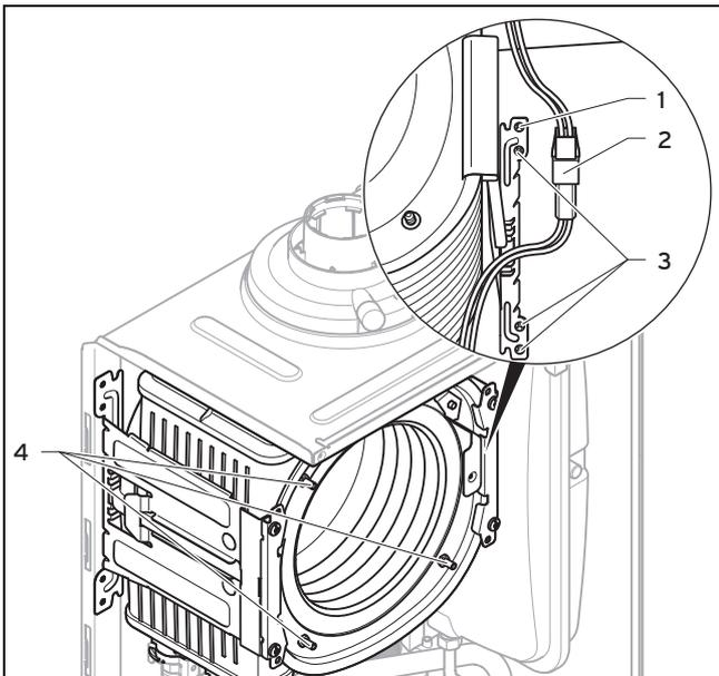
8. Trennen Sie die Steckverbindung **(2)** der thermischen Sicherung.
