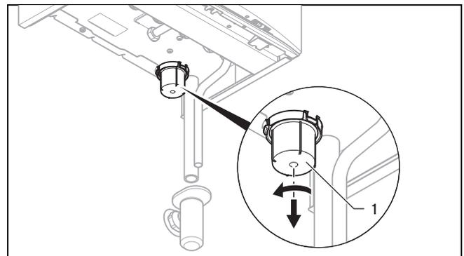
1. Nehmen Sie das Siphon-Unterteil (1) ab, indem Sie das Unterteil gegen den Uhrzeigersinn drehen.
