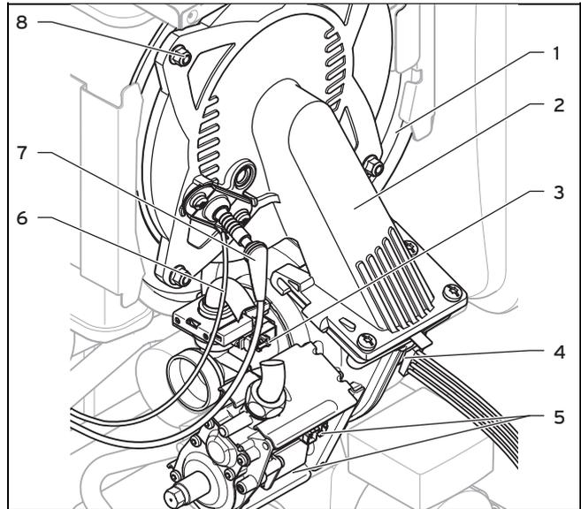
1. Stecken Sie das Thermo-Kompaktmodul (2) auf den Wärmetauscher (1).
