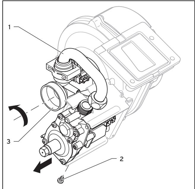
7. Nehmen Sie die gesamte Einheit aus Gebläse, Venturi und Gasarmatur aus dem Produkt.
