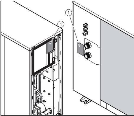
Die Typenbezeichnung und die Seriennummer befinden sich auf dem Typenschild (1).
