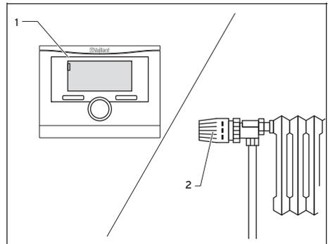
► Stellen Sie den Raumtemperaturregler oder den witterungsgeführten Regler (1) sowie die Heizkörper-Thermostatventile (2) gemäß den entsprechenden Anleitungen dieser Zubehörteile ein.
