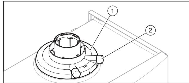
3. Messen Sie den CO<sub>2</sub>-Gehalt der Luft am Verbrennungsluftstutzen **(2)** des Geräteanschlussstücks **(1)**.
