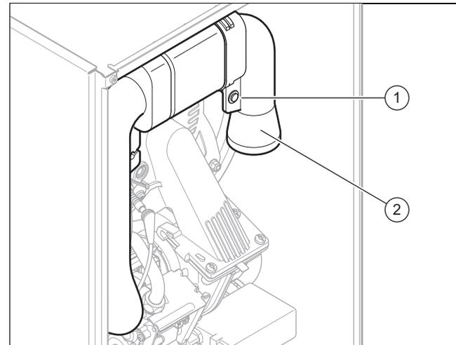
5. Lösen Sie die Schraube (1) und entfernen Sie das Luftansaugrohr (2).
