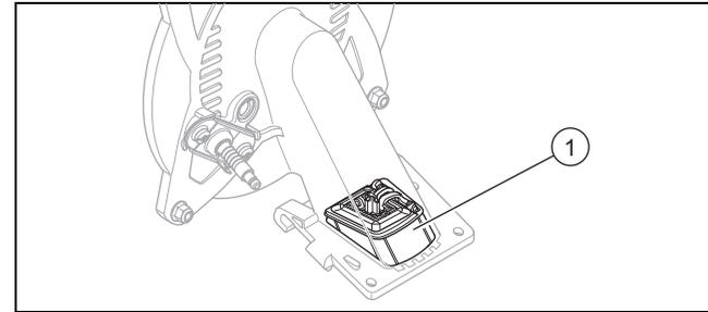
13. Montieren Sie die Rückströmsicherung (1) unten in das Gemischrohr.
