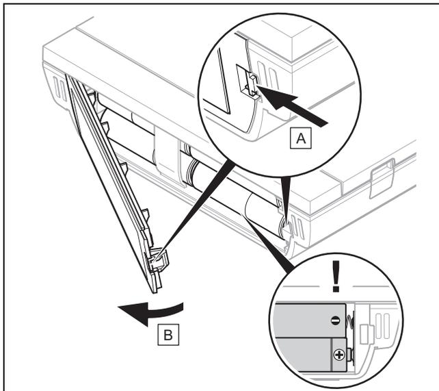
2. Öffnen Sie das Batteriefach gemäß der Abbildung.
