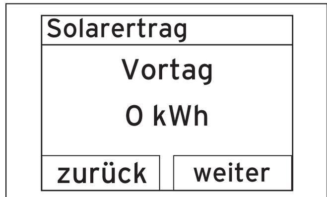
Aus der Grundanzeige heraus können Sie sich den Solarertrag in Kilowattstunden anzeigen lassen:
