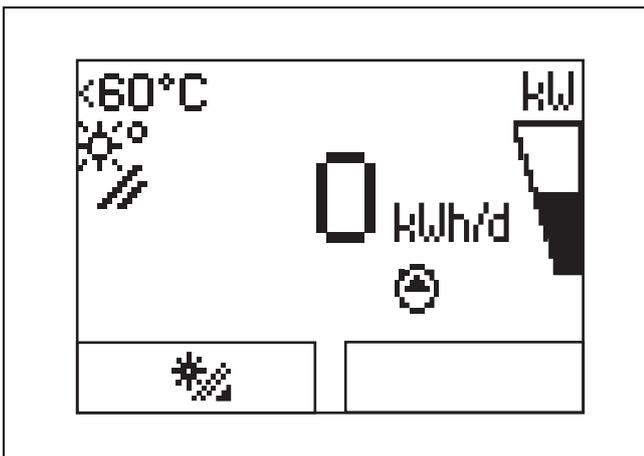
Im normalen Betriebszustand sehen Sie im Display die Grundanzeige. Die Grundanzeige zeigt den aktuellen Zustand an. Wenn Sie drücken, dann wird im Display der Solarertrag angezeigt. Wenn das Display abgedunkelt war, wird durch den ersten Tastendruck zunächst die Beleuchtung eingeschaltet. Um die Tastenfunktion auszulösen, müssen Sie in diesem Fall die Taste erneut drücken.
