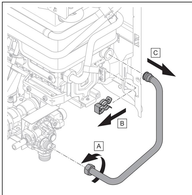
5. Dévissez l'écrou-raccord de la vanne d'eau. Retirez l'attache du raccord d'eau froide du brûleur.
