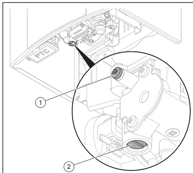
1. Tournez le sélecteur de température jusqu'à la butée dans le sens des aiguilles d'une montre pour réduire la quantité d'eau et régler la température maximale de l'eau.
