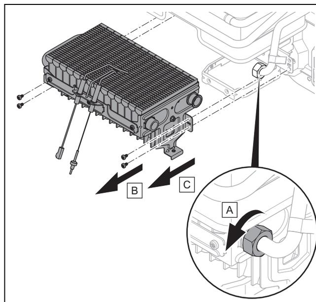
11. Dévissez l'écrou-raccord du raccord d'eau de l'échangeur thermique du brûleur.
