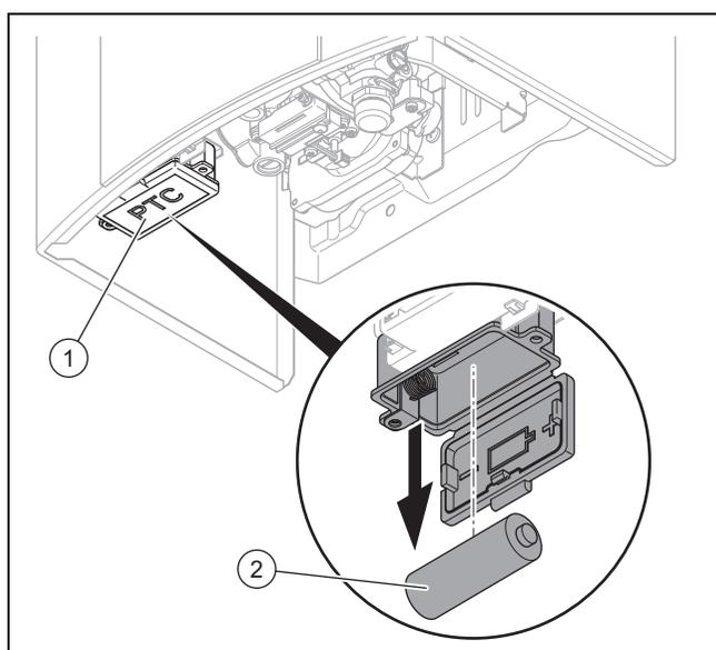
1. Faites en sorte qu'aucun robinet d'eau chaude ne doit ouvert lors du changement de la pile.
