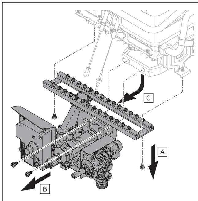
7. Retirez l'électrode d'allumage et l'électrode de surveillance qui sont raccordées au boîtier électrique.
