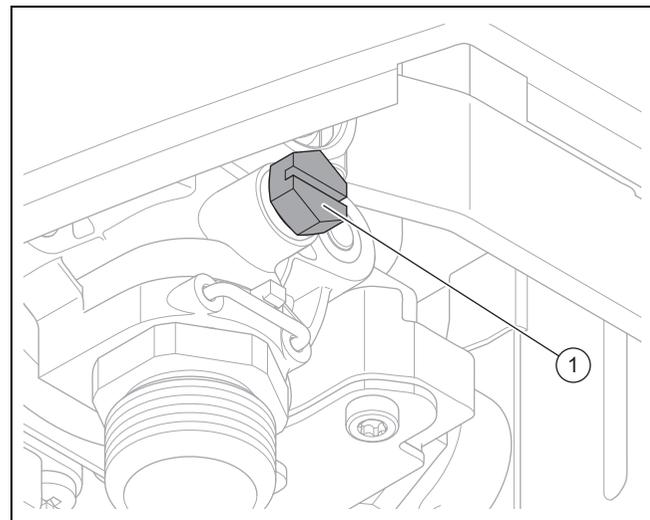
1. Desserrez la vis de vidange (1) et la rondelle d'étanchéité pour la vidange.
