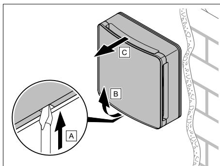
3. Szerelje le a ventilátoregységet a szélvédővel és az elülső burkolattal együtt.
