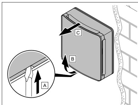
3. Demontujte jednotku ventilátoru s ochranou před větrem a předním panelem.
