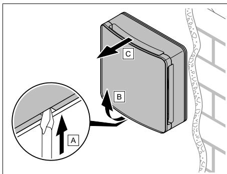
3. Irrota puhallinyksikkö sekä tuulensuoja ja etusuojus.
