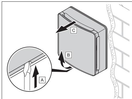
3. Smontare l'unità di ventilazione con la protezione antivento ed il rivestimento anteriore.
