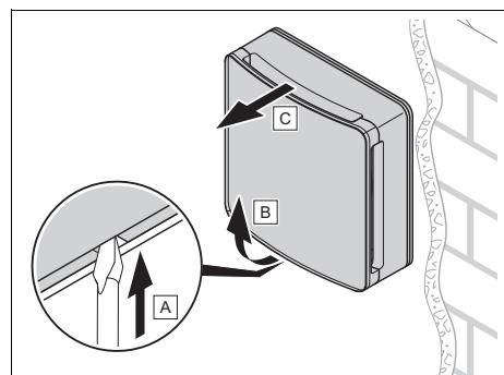
3. Desmonte a unidade de ventilador com a proteção contra vento e a guarnição dianteira.
