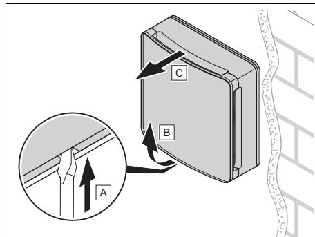
3. Demontujte jednotku ventilátora s ochranou proti vetru a čelným krytom.
