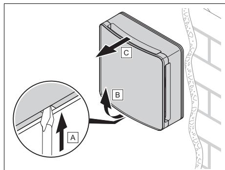
3. Demontujte jednotku ventilátoru s ochranou před větrem a předním panelem.
