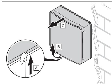
3. Irrota puhallinyksikkö sekä tuulensuoja ja etusuojus.
