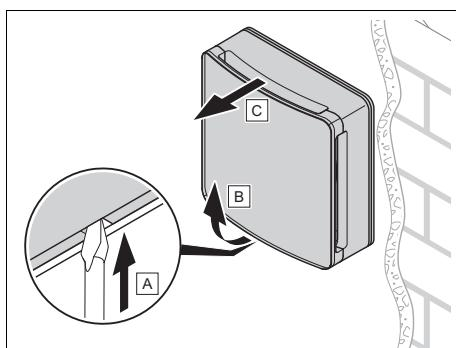
3. Szerelje le a ventilátoregységet a szélvédővel és az előtérű burkolattal együtt.
