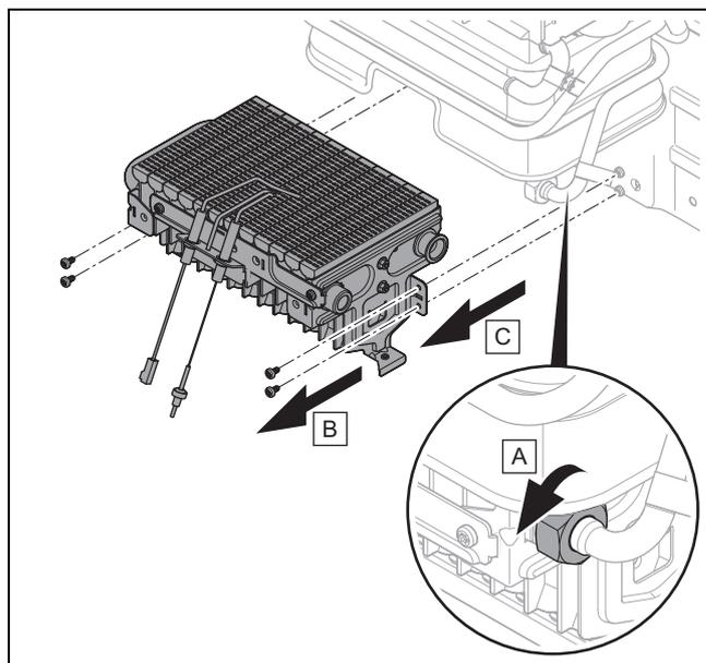
11. Schrauben Sie die Überwurfmutter des Wasseranschlusses des Wärmetauschers am Brenner ab.
