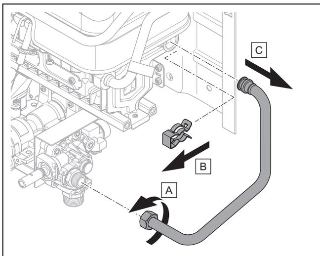
5. Schrauben Sie die Überwurfmutter am Wasserventil ab. Entfernen Sie den Clip am Kaltwasseranschluss des Brenners.
