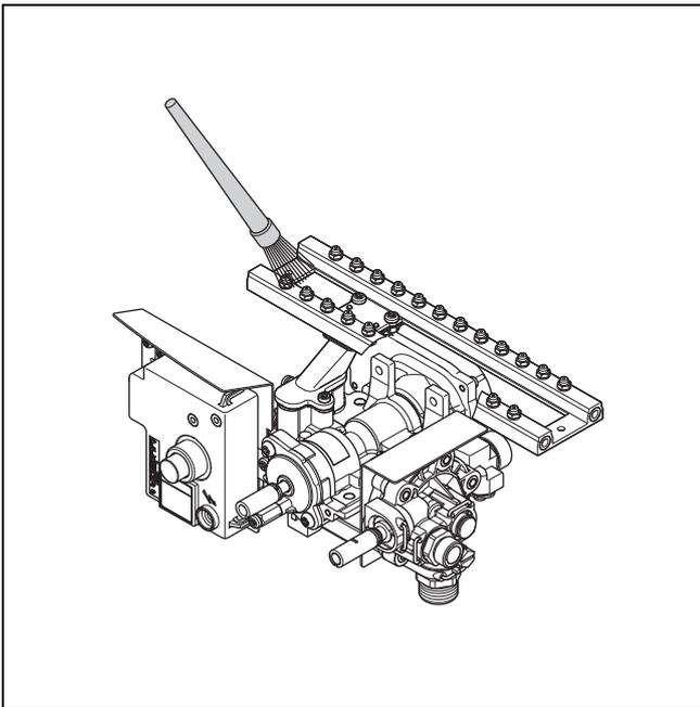
1. Prüfen Sie die Bauteile des Düsenstocks auf Verschmutzungen und Beschädigungen. Demontieren Sie auf keinen Fall die Brennerdüsen!
