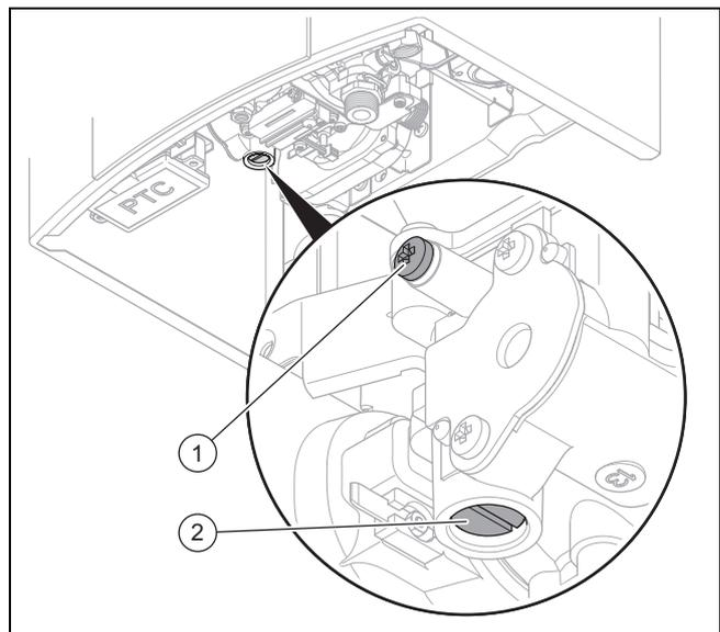
1. Drehen Sie den Temperaturwähler bis zum Anschlag im Uhrzeigersinn, um die Wassermenge zu verringern und die maximale Wassertemperatur einzustellen.
