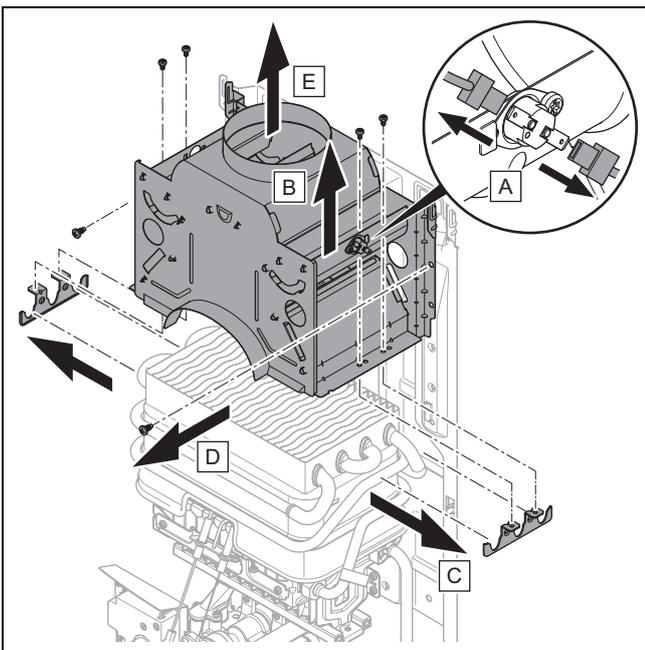
1. Ziehen Sie die Kabel am Abgassensor ab.
