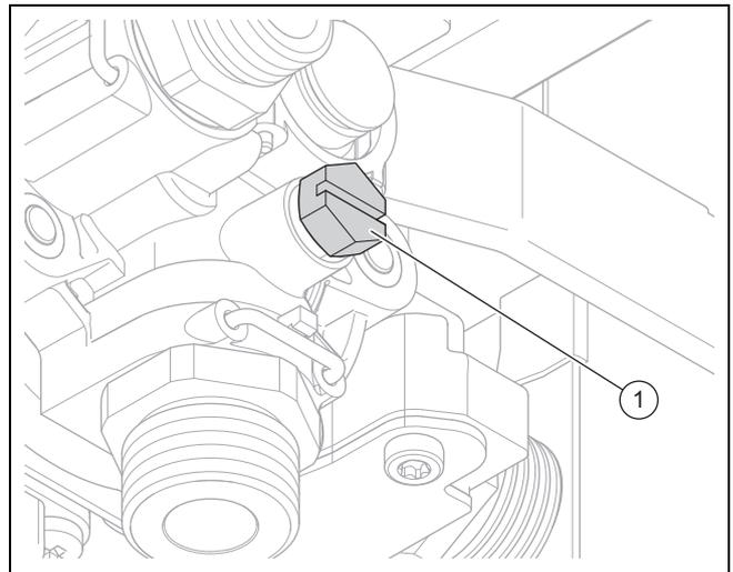
1. Lösen Sie die Entleerungsschraube **(1)** und den Dichtungsring für die Entleerung.
