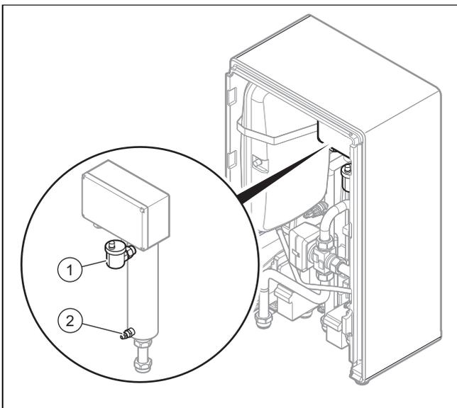
1. Stecken Sie einen Schlauch am Entleerungshahn (2) ein oder stellen Sie einen Behälter darunter, um den Hydraulikkreis zu entleeren.
