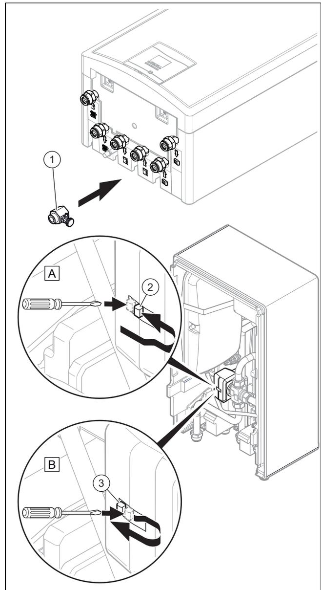
1. Schließen Sie das Füllset (1) an einem der Ein-/Ausläufe des Moduls an.
