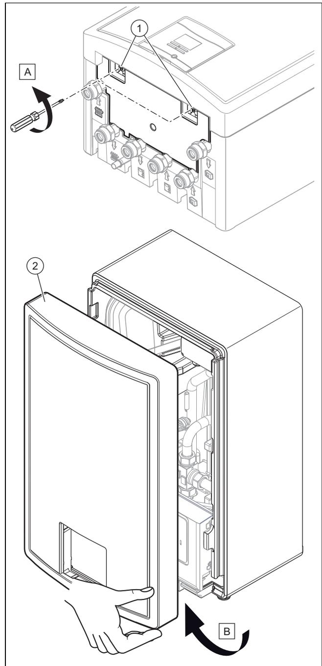
1. Lösen Sie die Schrauben (1).
