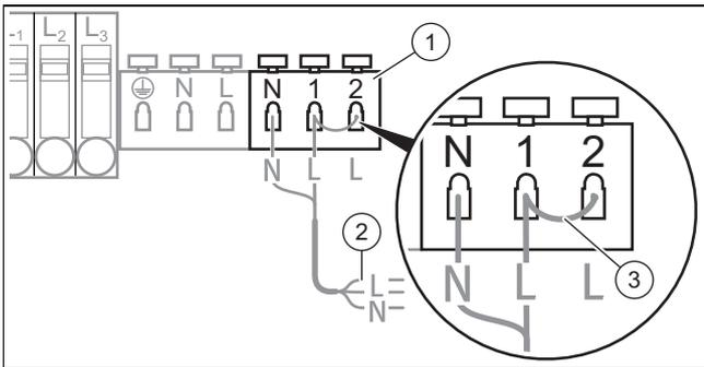
1. Schließen Sie das Kabel (2) am Steuerrelais (1) an.
