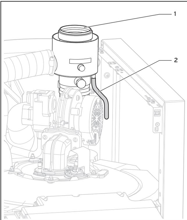
1. Schließen Sie vor dem Befüllen des Siphons die Kondensatablaufleitung an der Rückseite des Produkts an. Beachten Sie die Hinweise zur Verlegung der Kondensatablaufleitung im Kapitel „Kondensatablaufleitung anschließen“ (→ Seite 13)“.
