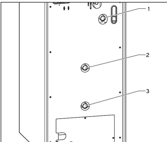
1. Bauen Sie zwischen Heizungsanlage und Produkt die erforderlichen bauseits zu stellenden Sicherheits- und Absperrrichtungen sowie einen Füll- und Entleerungshahn im Rücklauf ein.
