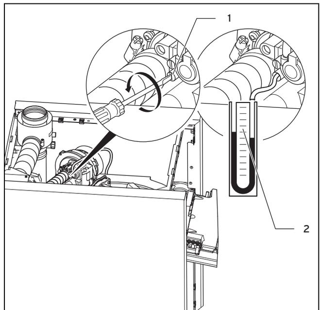
3. Lösen Sie die mit „in“ gekennzeichnete Dichtungsschraube (1) an der Gasarmatur.
