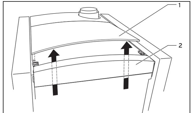
3. Fassen Sie von unten hinter der Blende (2) durch und drücken Sie die obere Verkleidung (1) hoch.
