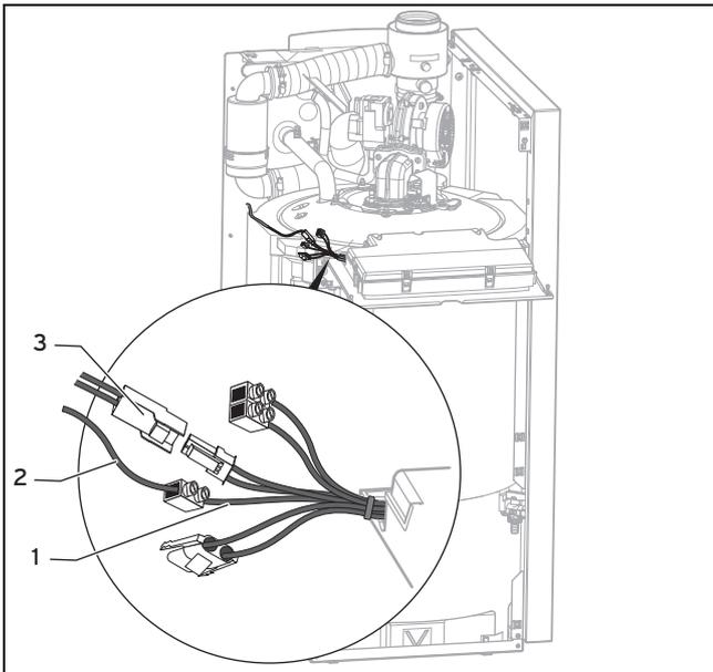
1. Schließen Sie den Speichertemperaturfühler (3) und ggf. den Ladetemperaturfühler (2) (nur actoSTOR, Anschlusskabel Schaltkasten Farbe violett (1)) am Kabelbaum an.
