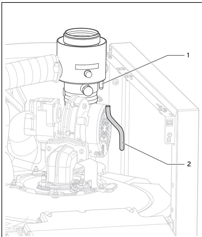
1. Ziehen Sie die Spülleitung **(2)** vom Luft-Abgas-Anschluss **(1)** ab.
