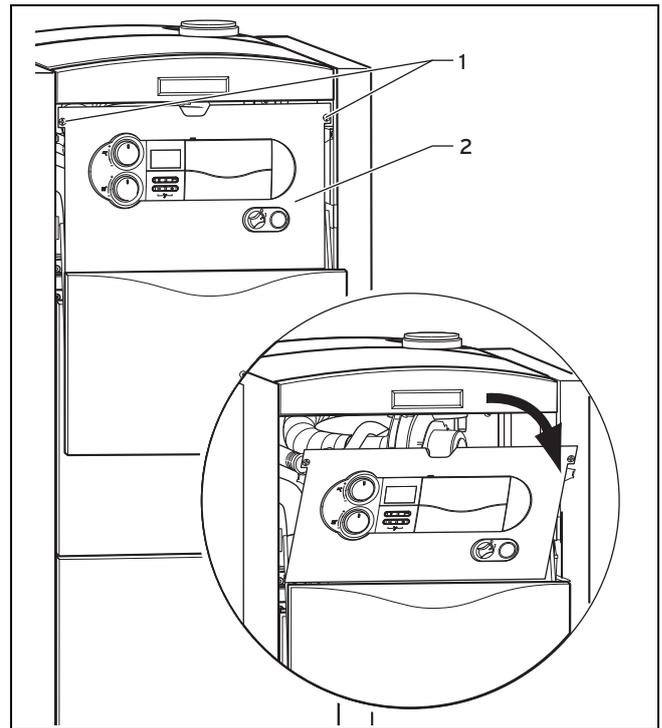
1. Drehen Sie die beiden Schrauben (1) um 90°.
