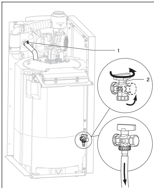
1. Schließen Sie die Wartungshähne des Produkts.
