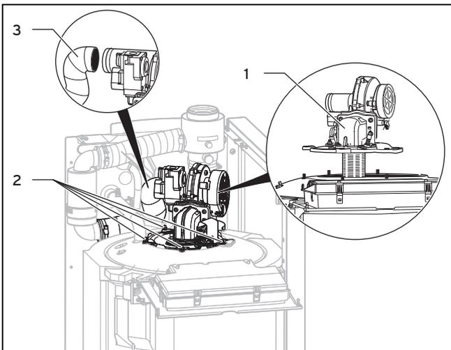
9. Ziehen Sie den Luftansaugschlauch (3) vom Gebläseanschluss ab.
