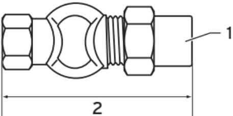
**3.2. ábra Átfolyókivitelű gázelzárócsap
