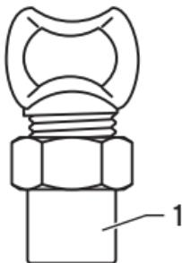
**Fig 3.1 Rubinetto di intercettazione del gas nella versione angolare N. modello GCAN DN 15, 20, 25**
