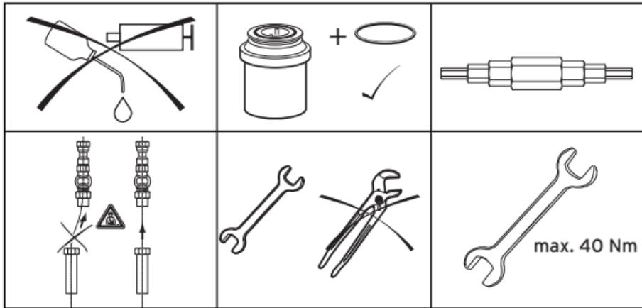
**Fig. 4.1 Avvertenze per il montaggio**
