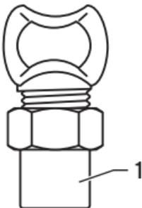
**Fig 3.1 Llave de paso del gas en modelo angular
