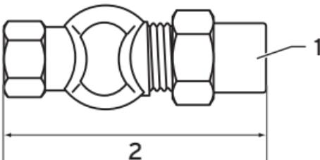
**Abb 3.2 Gasabsperrhahn in Durchgangsausführung
