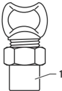
**Fig. 3.1 Robinet d'arrêt de gaz équerre
