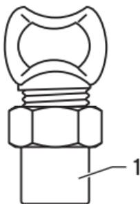
**Abb 3.1 Gasabsperrhahn in Eckausführung**
