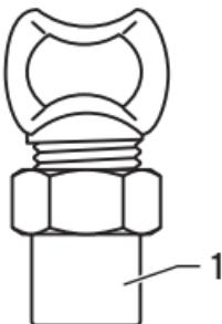
**SI 3.1 Plinski zaporni ventil v kotni izvedbi**
