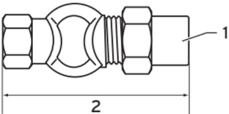
**Fig 3.2 Llave de paso del gas, modelo en sección de paso
