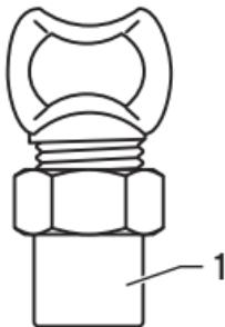
**Sl. 3.1 Zaporni plinski ventil u kutnoj izvedbi
