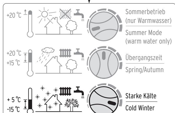
Hinweis: Bei Anschluss eines witterungsgeführten Reglers oder Raumtemperaturreglers: Einstellung „Starke Kälte“
