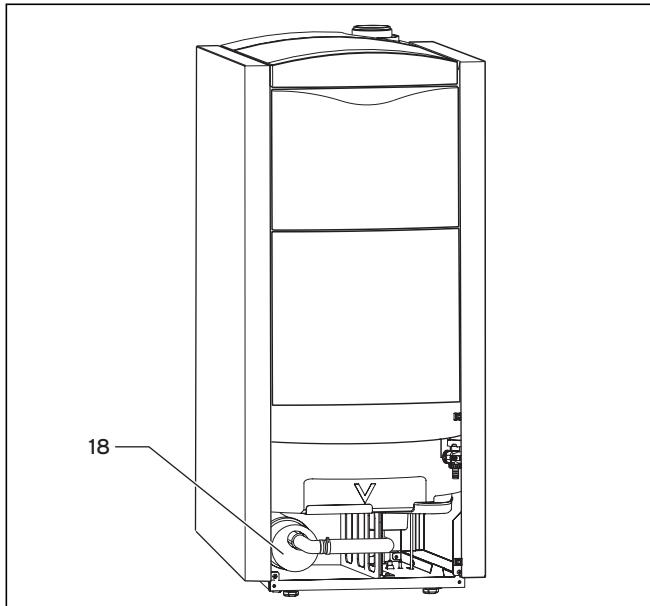
Abb. 4.1 Öl-Neutralisations-Einrichtung platzieren
