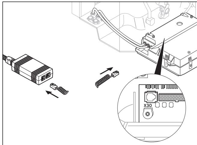
Afb. 6.2 Aansluiting eBUS-deelnemer op USB-adapter
