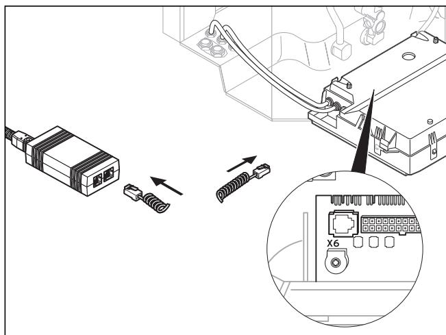
**Fig. 6.3 Forbindelse af kedel med Vaillant-pc-interface med
