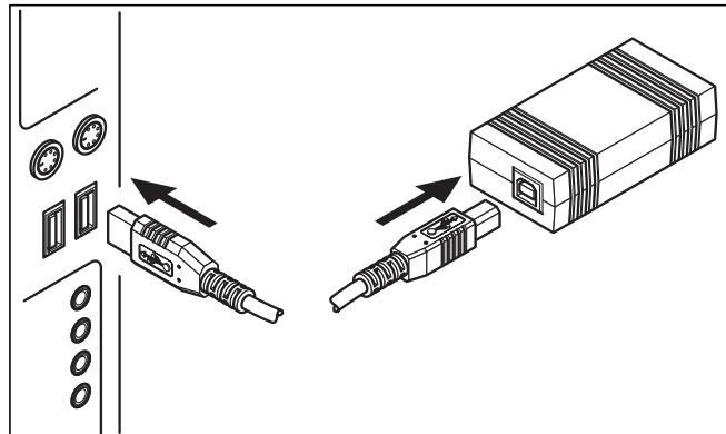
Fig. 6.1 Conexión del adaptador USB al ordenador
