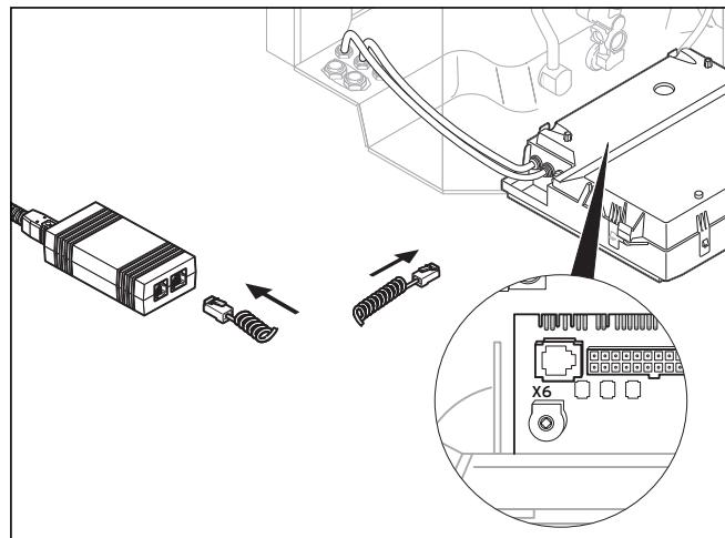
**Afb. 6.3 Aansluiting cv-toestel op Vaillant pc-interface met USB-adapter**
