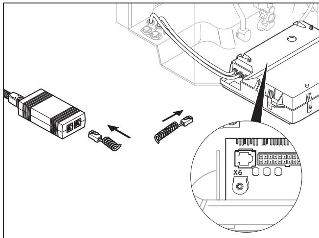
Abb. 6.3 Verbindung Heizgerät mit Vaillant-PC-Schnittstelle mit USB-Adapter
