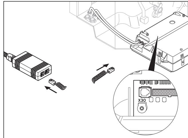
Abb. 6.2 Verbindung eBUS-Teilnehmer mit USB-Adapter
