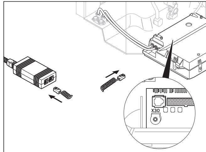
Fig. 6.2 Forbindelse af eBUS-deltager med USB-adapteren
