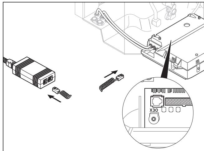
Fig. 6.2 Collegamento all'adattatore USB dell'utenza eBUS
