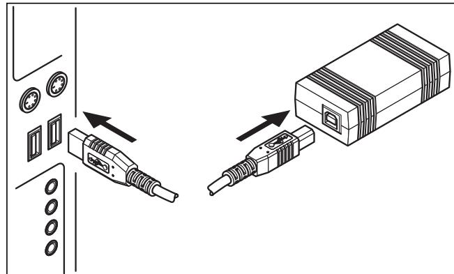
Fig. 6.1 Forbindelse af USB-adapteren med computeren
