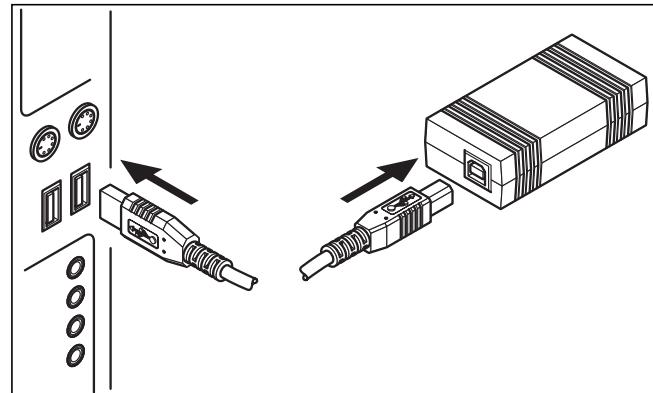
Abb. 6.1 Verbindung USB-Adapter mit Computer
