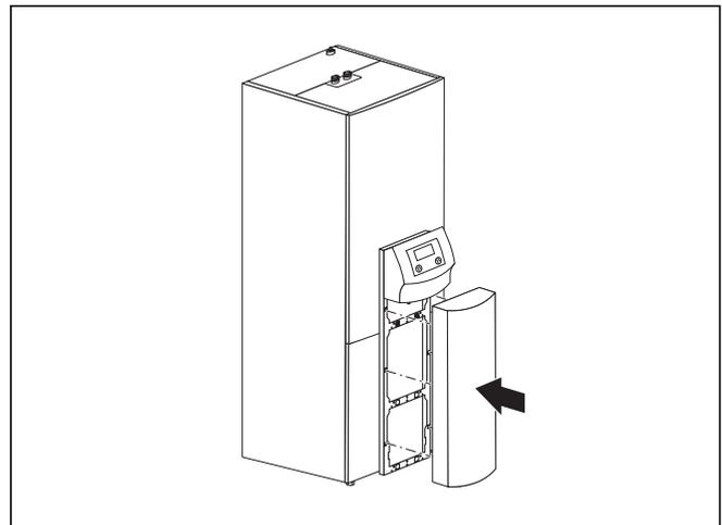
Abb. 1.1 Säulenabdeckung entfernen
