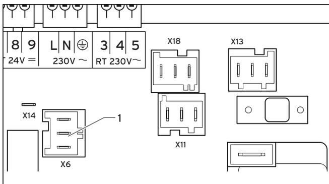
Abb. 5.4 Elektrischer Anschluss der Speicherladepumpe
