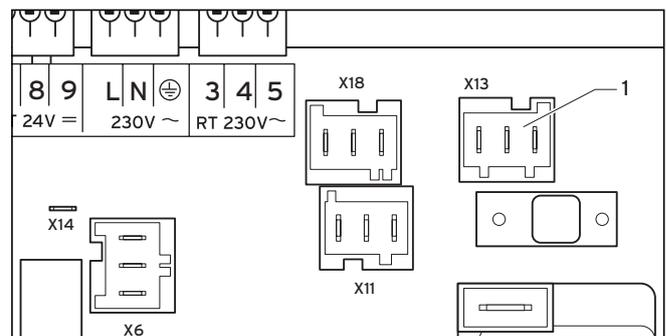
**Abb. 5.2 Elektrischer Anschluss Heizungspumpe hinter hydraulischer Weiche**
