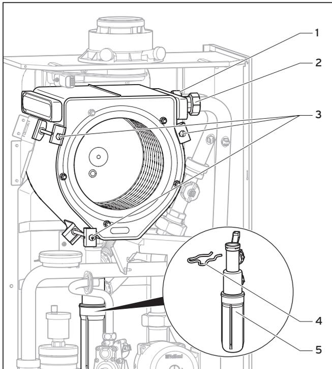
Abb. 10.3 Integral-Kondensations-Wärmetauscher austauschen
