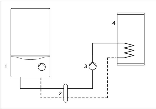
Abb. 5.3 Speichervorrangschaltung über hydraulische Weiche
