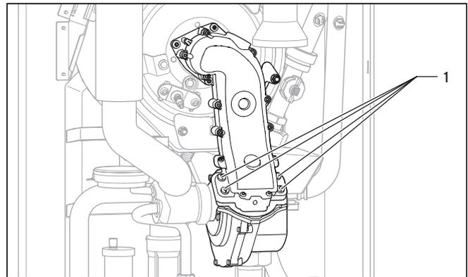
Abb. 10.2 Verschraubung Gasarmatur/Gebläse
