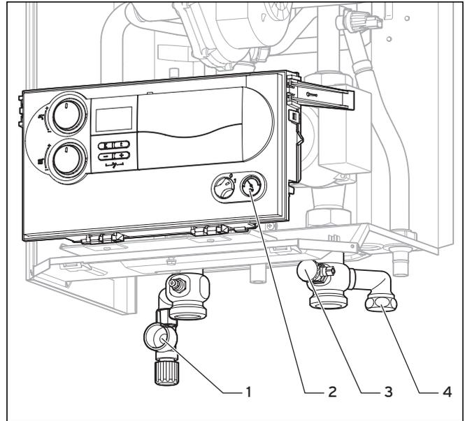
Abb. 5.9 Sicherheitsventil montieren
