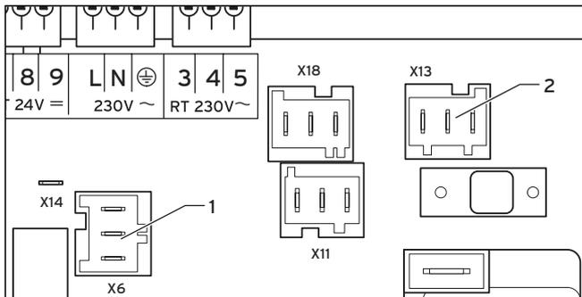
**Abb. 5.6 Elektrischer Anschluss Speicherladepumpe und externe Heizpumpe**
