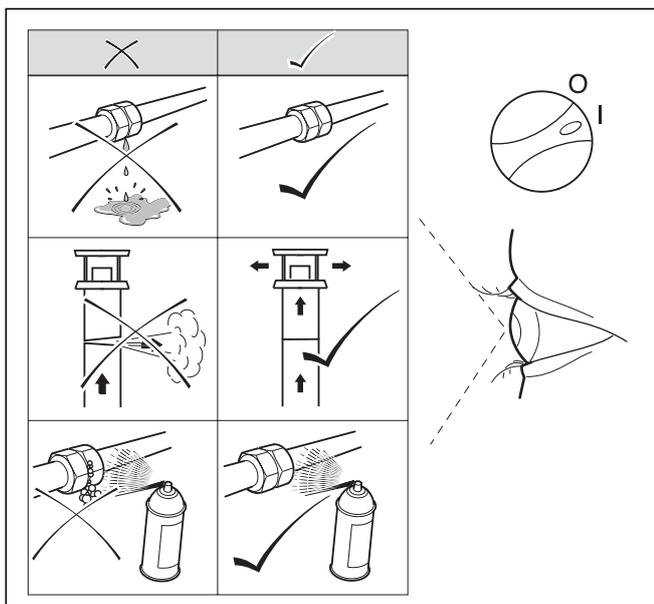
Abb. 8.8 Dichtheitsprüfung
