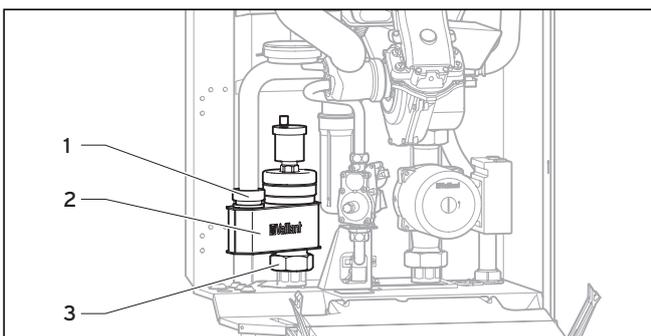
Abb. 8.6 Luftabscheidesystem reinigen
