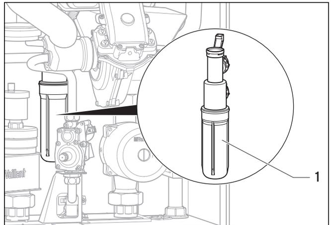
Abb. 8.4 Kondenswassersiphon reinigen
