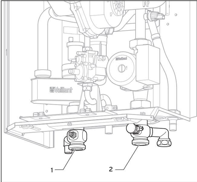
Abb. 5.8 Heizungsanschluss
