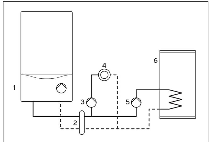
Abb. 5.5 Speichervorrangschaltung und Heizkreis über hydraulische Weiche
