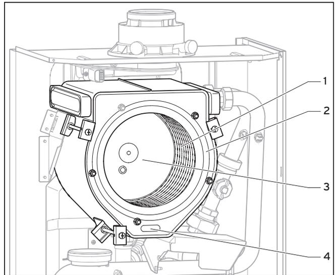
Abb. 8.2 Integral-Kondensations-Wärmetauscher reinigen
