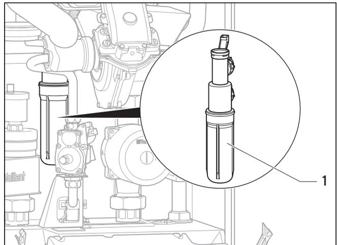
Abb. 6.4 Siphon befüllen
