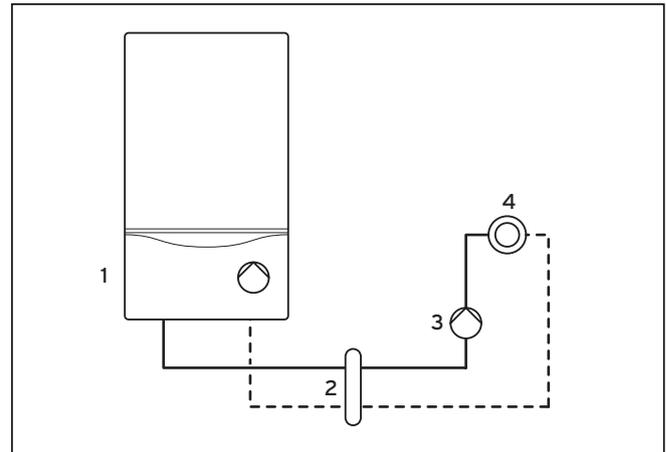
**Abb. 5.1 Heizkreisbindung mit hydraulischer Weiche**
