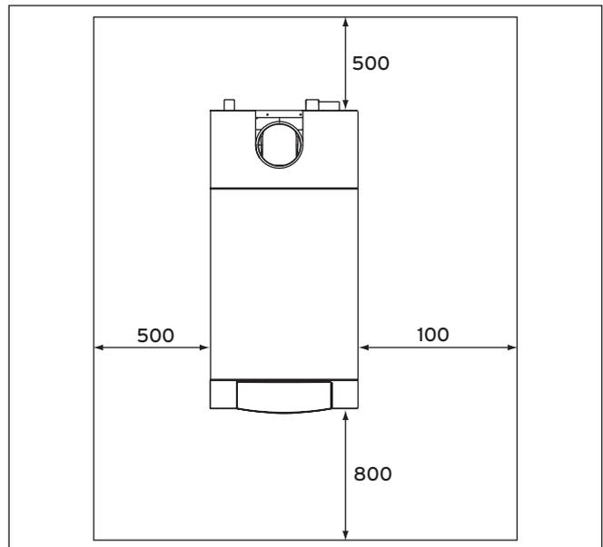
Abb. 4.2 Empfohlene Abstände bei der Aufstellung (in mm)
