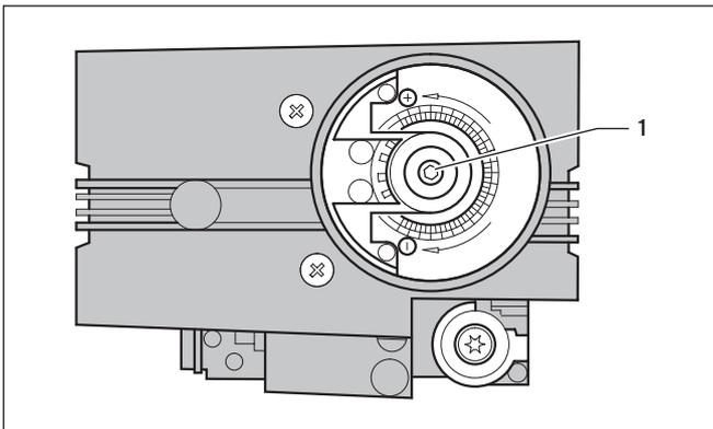
Abb. 6.3 Gasdurchflussschraube
