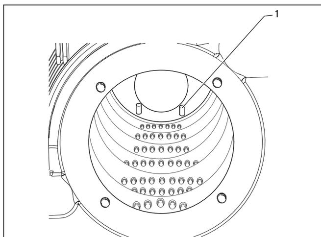
Abb. 8.7 Führungsnuten des Brenners
