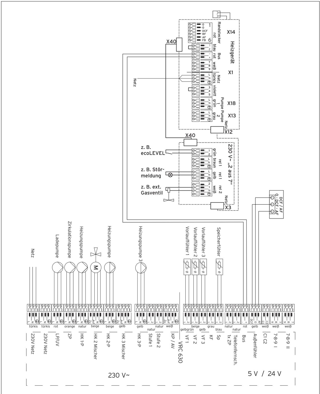
Abb. 5.10 Anschluss Regelgerät VRS 620, VRC 630
