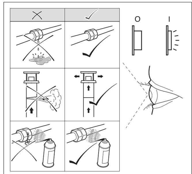
Abb. 6.5 Sicht- und Dichtprüfung des Gerätes und der Anlage
