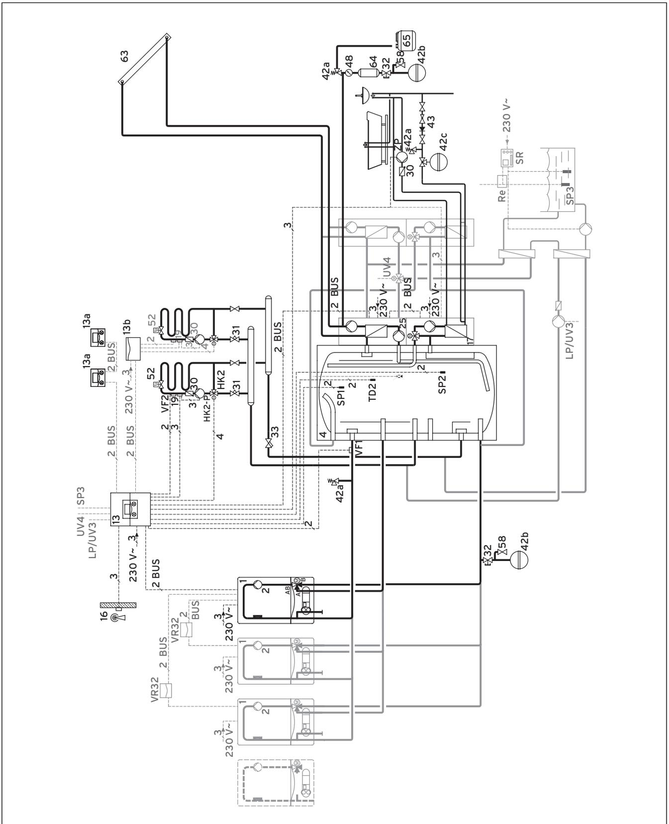
Abb. 3.9 Anschlussschema Gas-Wandheizgeräte
