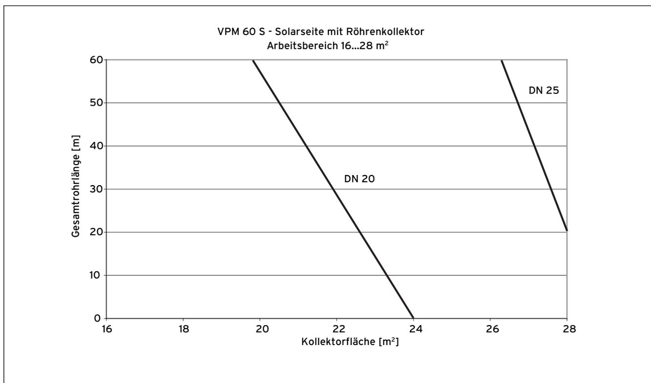
Abb. 3.19 Bestimmung Nenndurchmesser DN
