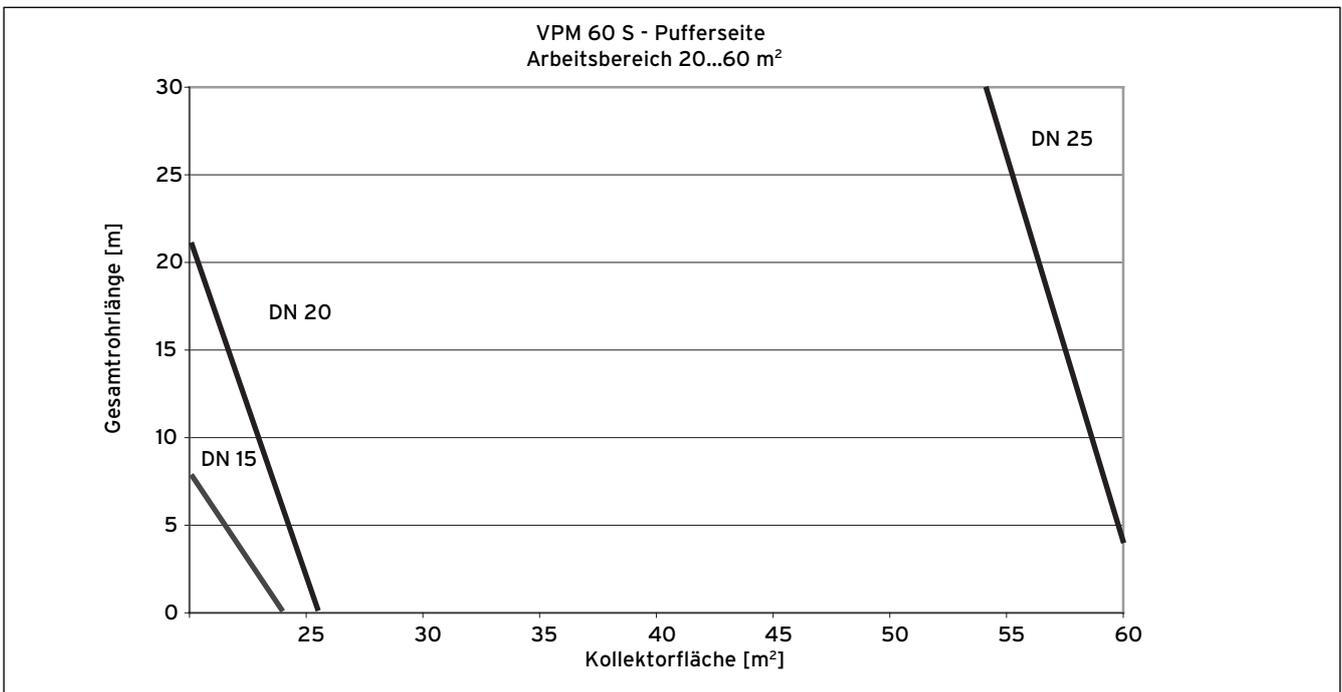
Abb. 3.17 Bestimmung Nenndurchmesser DN
