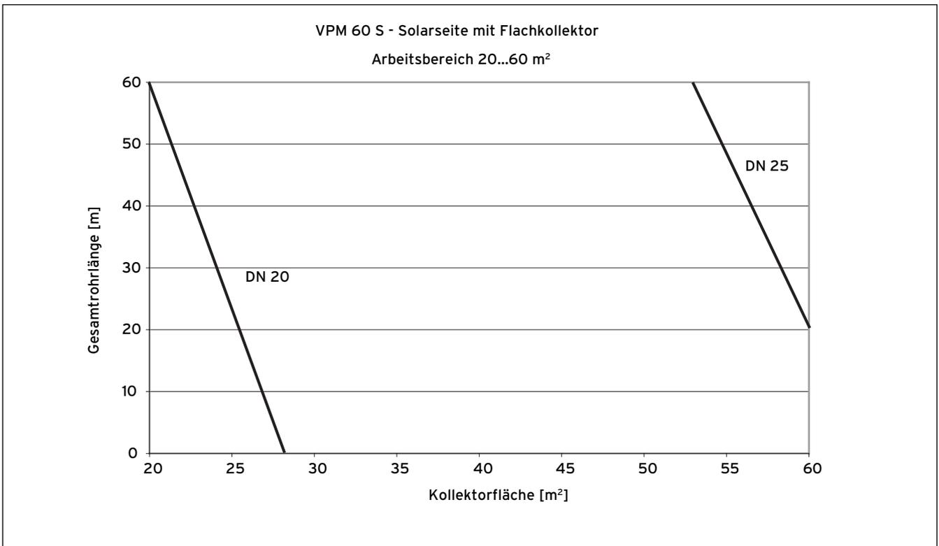
Abb. 3.21 Bestimmung Nenndurchmesser DN
