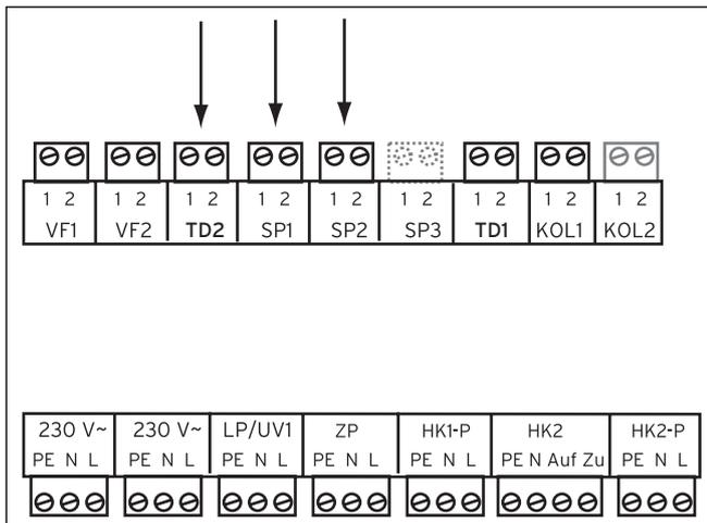
Abb. 4.3 Verdrahtung Solarsystemregler
