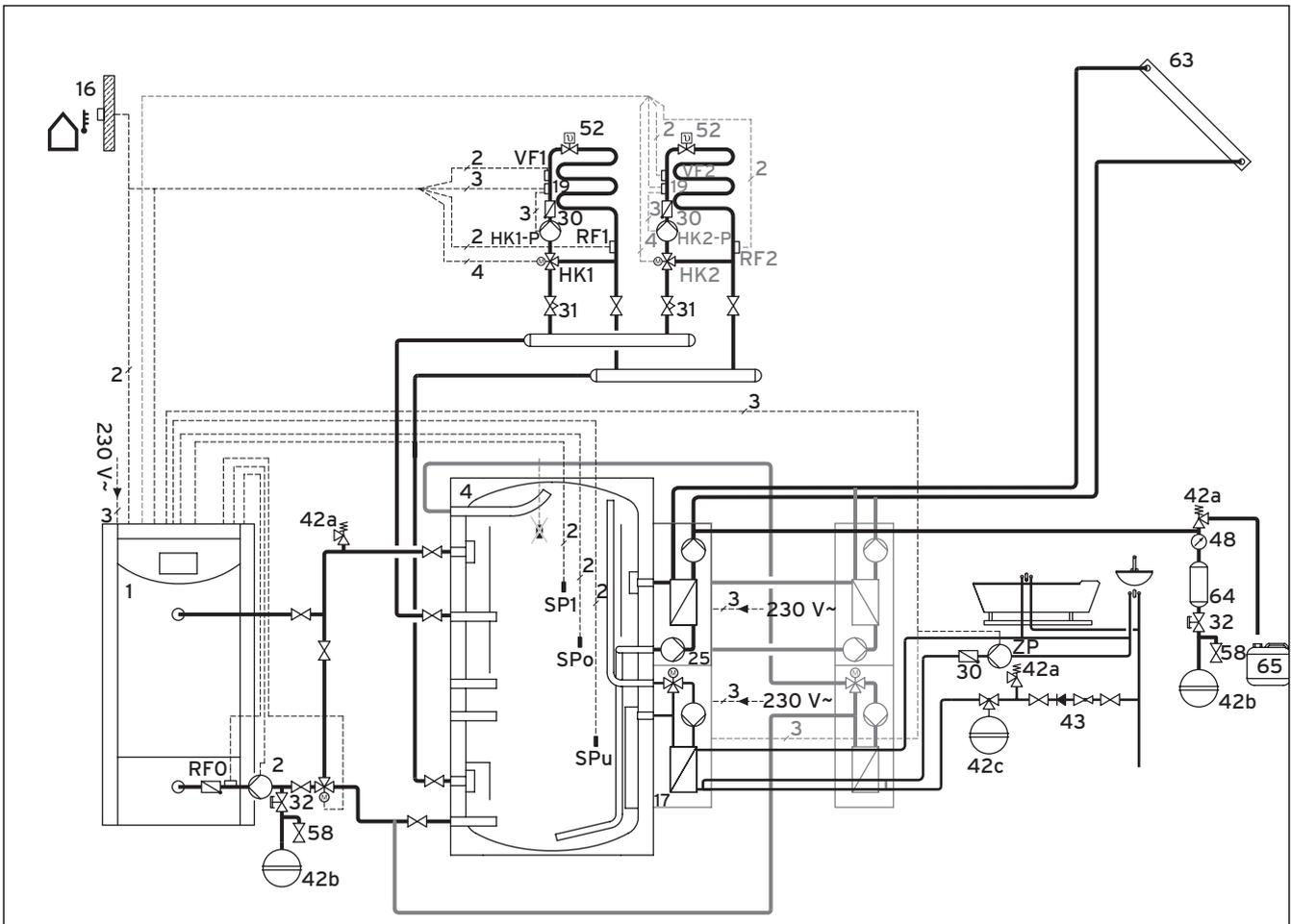
Abb. 3.10 Anschlussschema Pellet-Heizkessel
