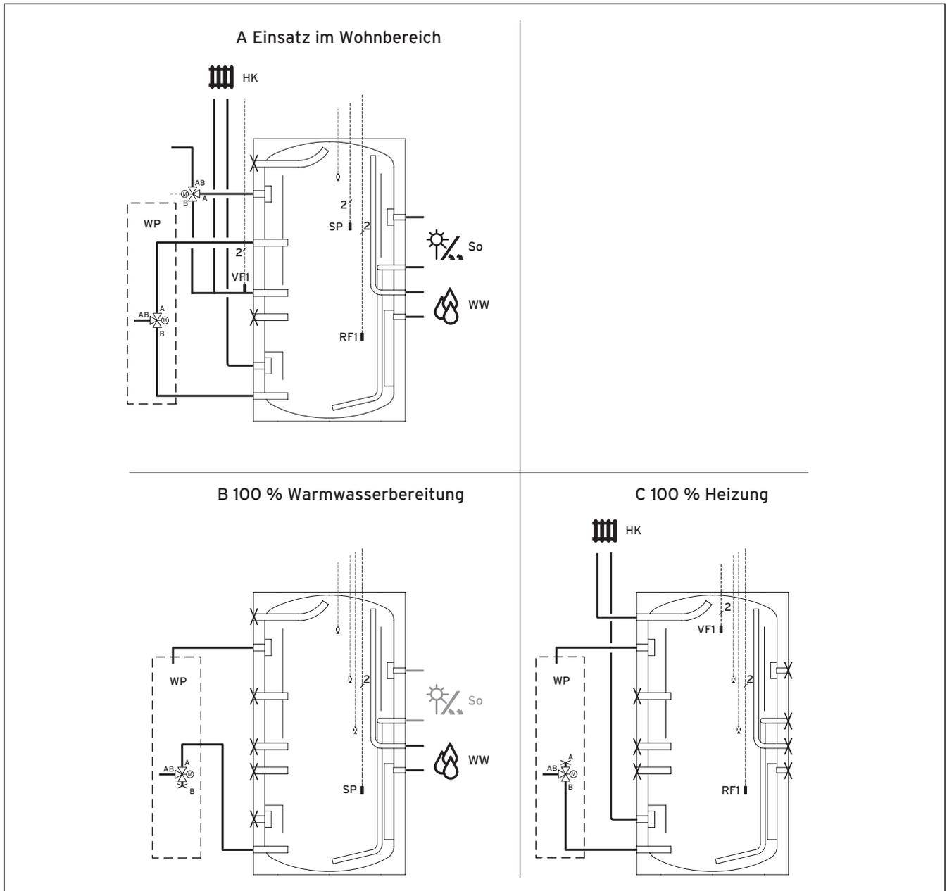
Abb. 3.13 Anwendungsbeispiele geoTHERM
