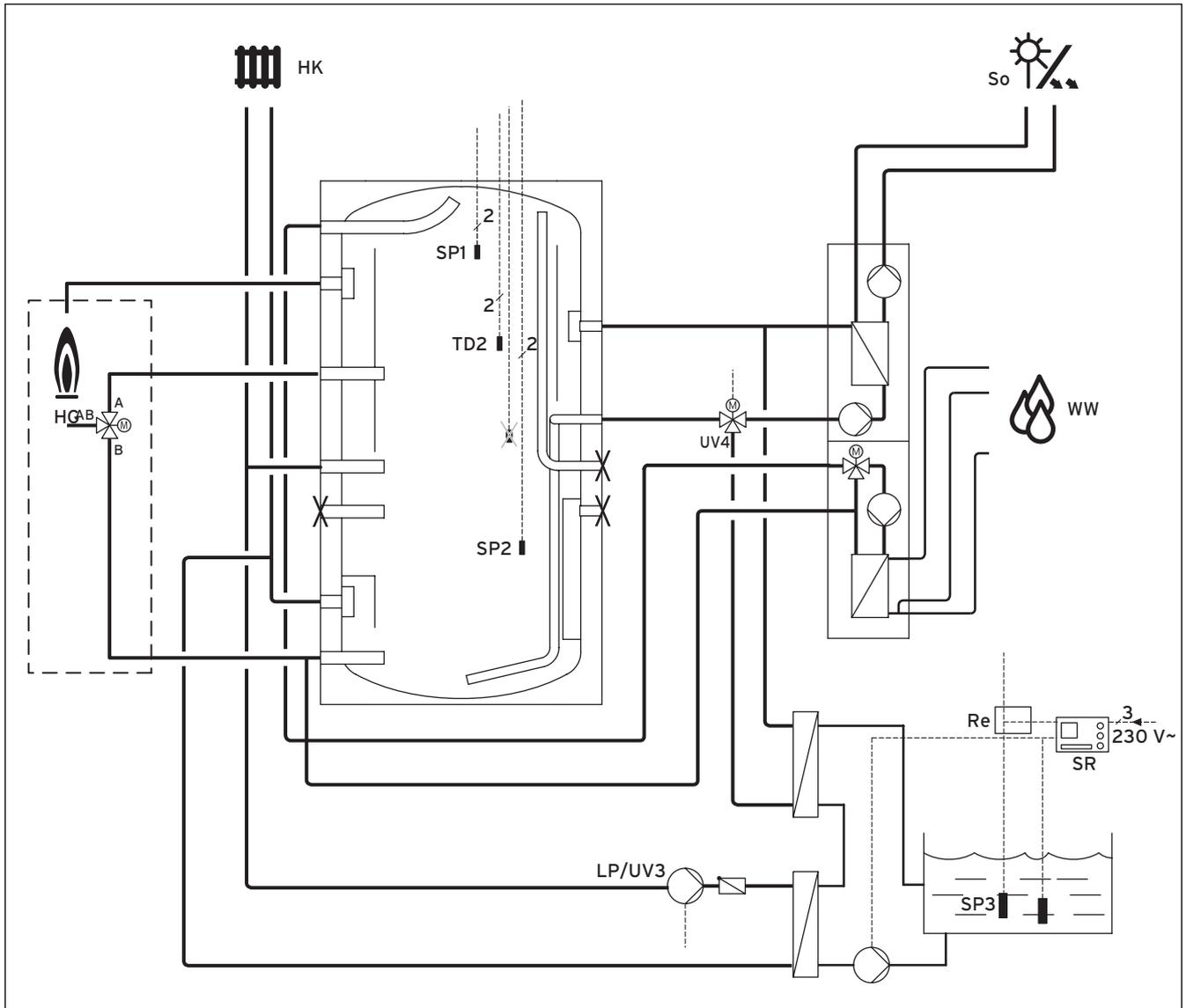
Abb. 3.14 Detail-Plan Schwimmbadbeheizung
