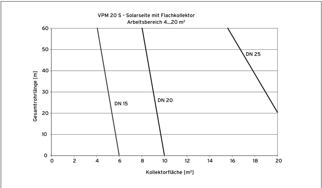
Abb. 3.20 Bestimmung Nenndurchmesser DN
