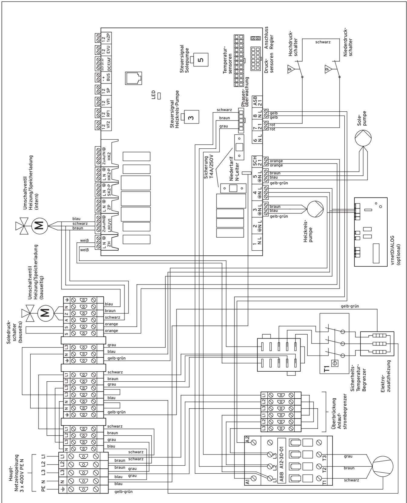
Abb. 2, Anhang, Stromlaufplan Inneneinheit VWL 61/3 S - VWL 101/3 S
