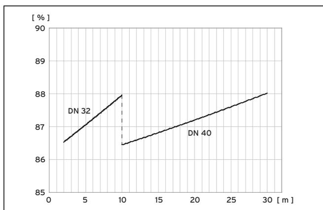
Abb. 9.1 Diagramm Leistungsoptimierung Solepumpe VWL 61/3 S
