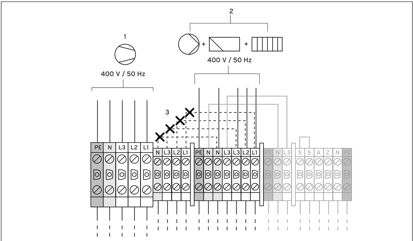
**Abb. 7.7 Zweikreis-Einspeisung Wärmepumpen-Tarif**
