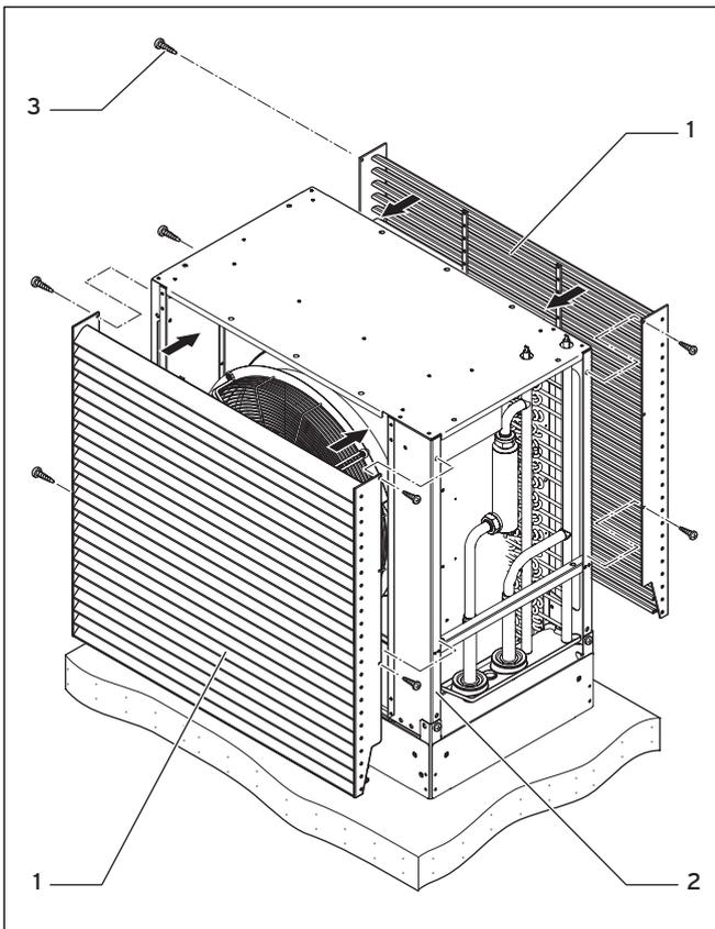
Abb. 7.26 Lamellengitter einhängen
