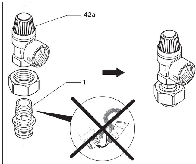
Abb. 5.9 Sicherheitsventil montieren
