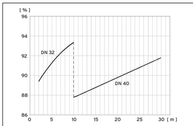
Abb. 9.3 Diagramm Leistungsoptimierung Solepumpe VWL 101 /3 S
