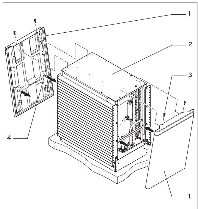
Abb. 7.27 Seitenverkleidungen montieren
