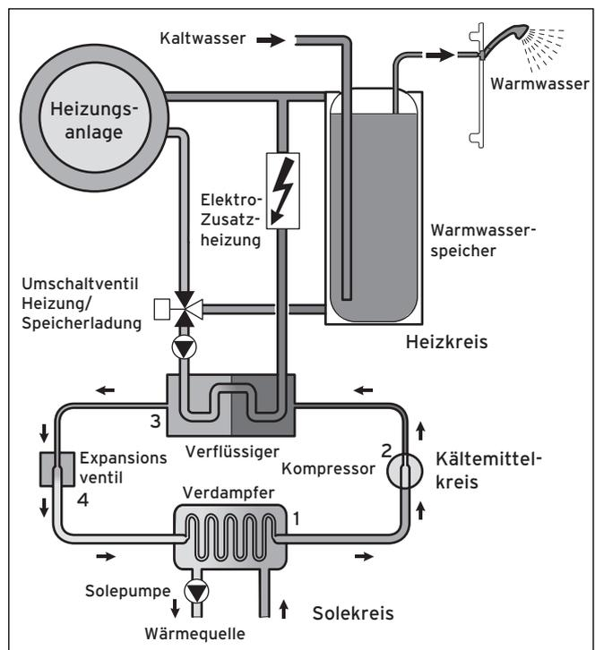
Abb. 3.4 Funktionsweise Wärmepumpe (Inneneinheit)
