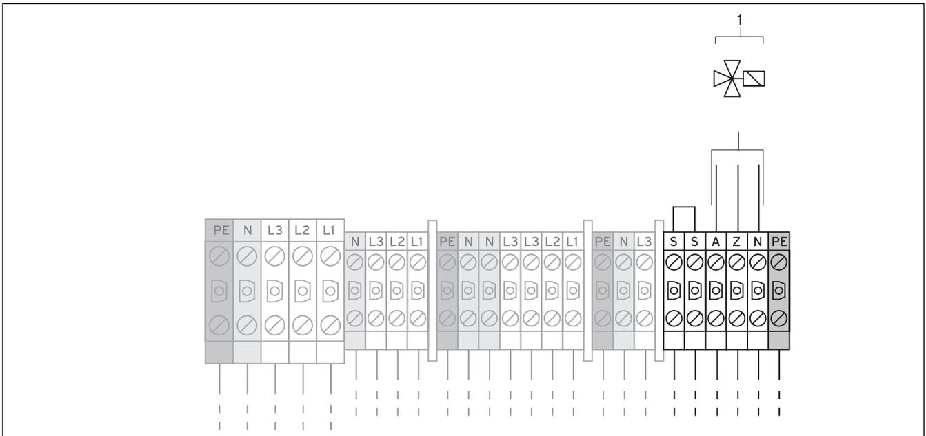
**Abb. 7.10 Externes 3-Wege-Ventil für Pufferspeicher anschließen**
