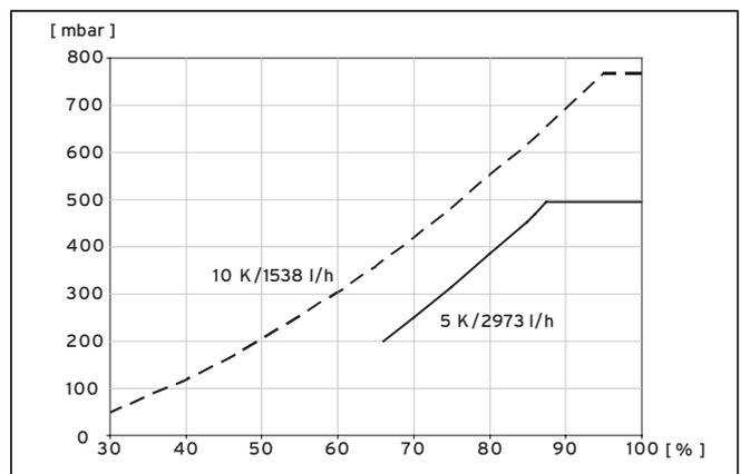
**Abb. 9.10 Diagramm Leistungsoptimierung Heizkreispumpe VWL 171/3 S**
