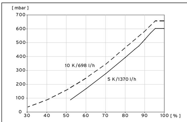
**Abb. 9.7 Diagramm Leistungsoptimierung Heizkreispumpe VWL 81/3 S**
