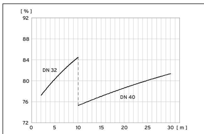
Abb. 9.4 Diagramm Leistungsoptimierung Solepumpe VWL 141/3 S
