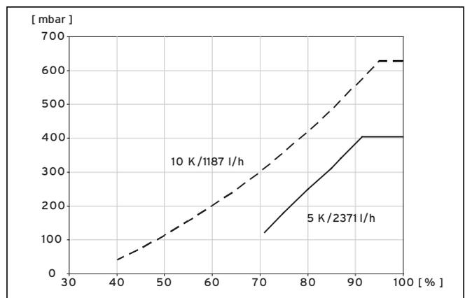
**Abb. 9.9 Diagramm Leistungsoptimierung Heizkreispumpe VWL 141/3 S**
