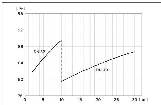
Abb. 9.5 Diagramm Leistungsoptimierung Solepumpe VWL 171/3 S
