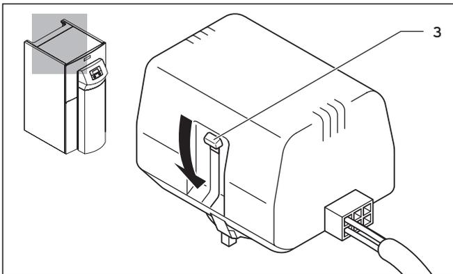
**Abb. 6.2 Umschaltventil Heizung/Speicherladung**
