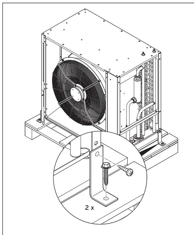
Abb. 4.11 Transportsicherungen der Außeneinheit entfernen
