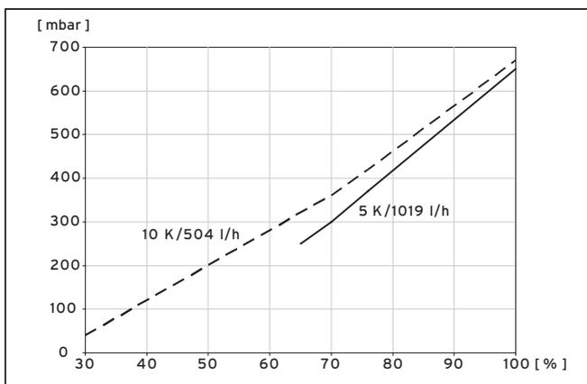
**Abb. 9.6 Diagramm Leistungsoptimierung Heizkreispumpe VWL 61/3 S**
