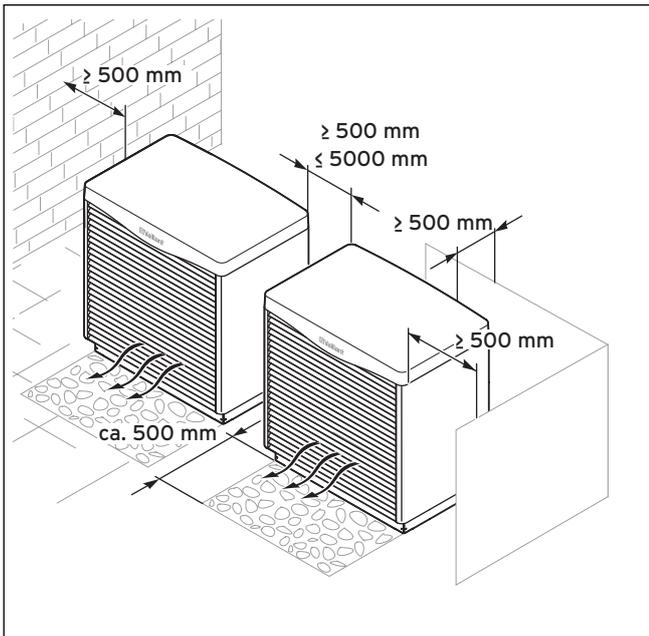
Abb. 4.5 Mindestabstände zur Aufstellung zweier Außeneinheiten
