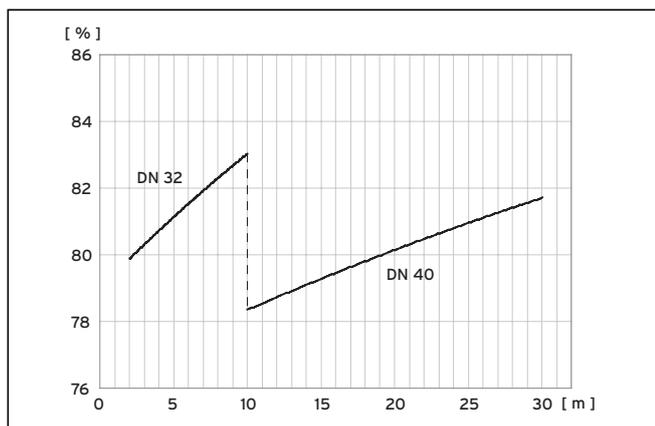
Abb. 9.2 Diagramm Leistungsoptimierung Solepumpe VWL 81/3 S
