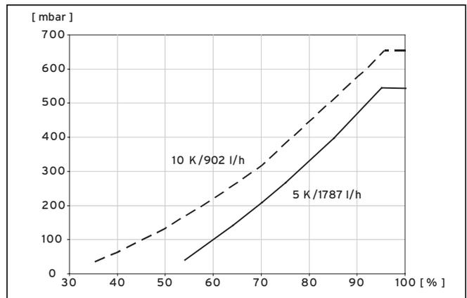
**Abb. 9.8 Diagramm Leistungsoptimierung Heizkreispumpe VWL 101/3 S**
