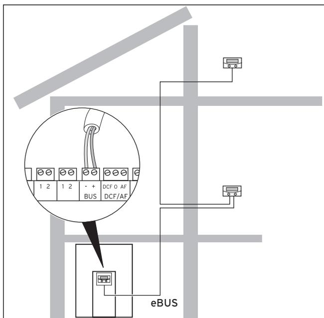
**Abb. 7.15 Fernbediengeräte installieren**
