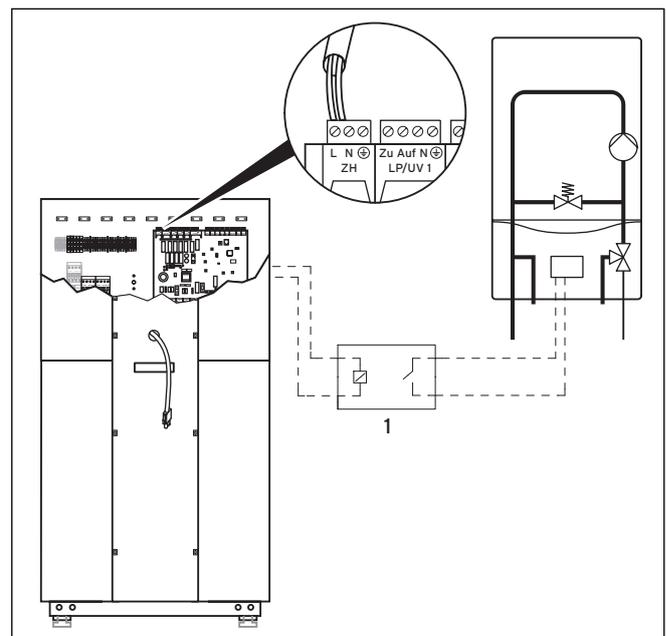
Abb. 7.18 Heizgerät ohne eBUS-Schnittstelle anschließen
