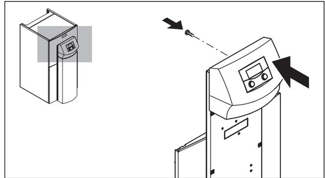
**Abb. 7.20 Bedienkonsole montieren**
