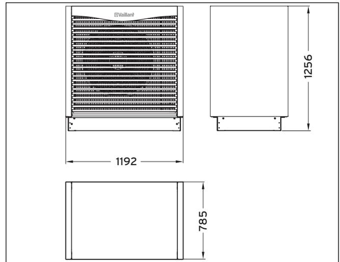
Abb. 4.3 Abmessungen Außeneinheit
