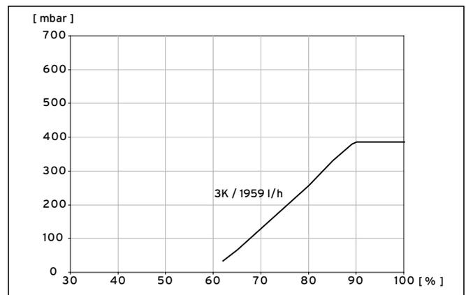
9.2 Diagramm Leistungsoptimierung Solepumpe VWS 83/3
