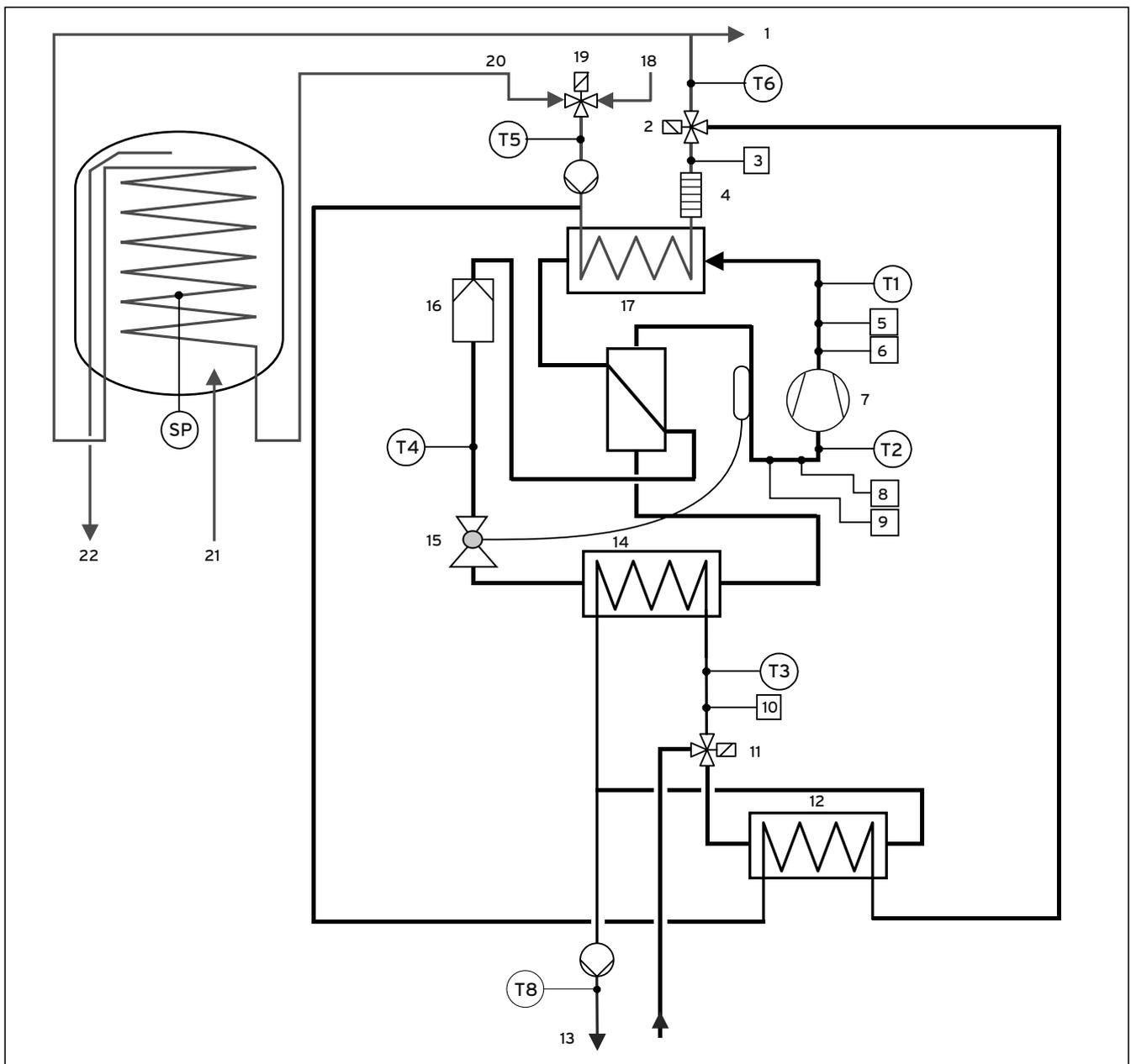
17.1 Wärmepumpenschema VWS mit integriertem Warmwasserspeicher
