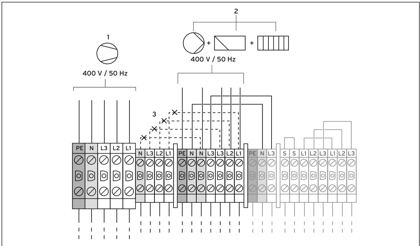
7.5 Zweikreis-Einspeisung Wärmepumpen-Tarif
