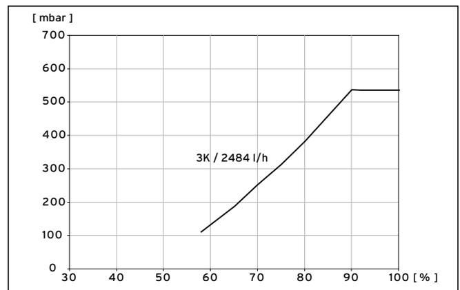
9.3 Diagramm Leistungsoptimierung Solepumpe VWS 103/3
