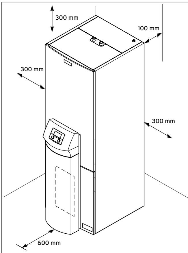
4.2 Mindestabstände zur Aufstellung der Wärmepumpe
