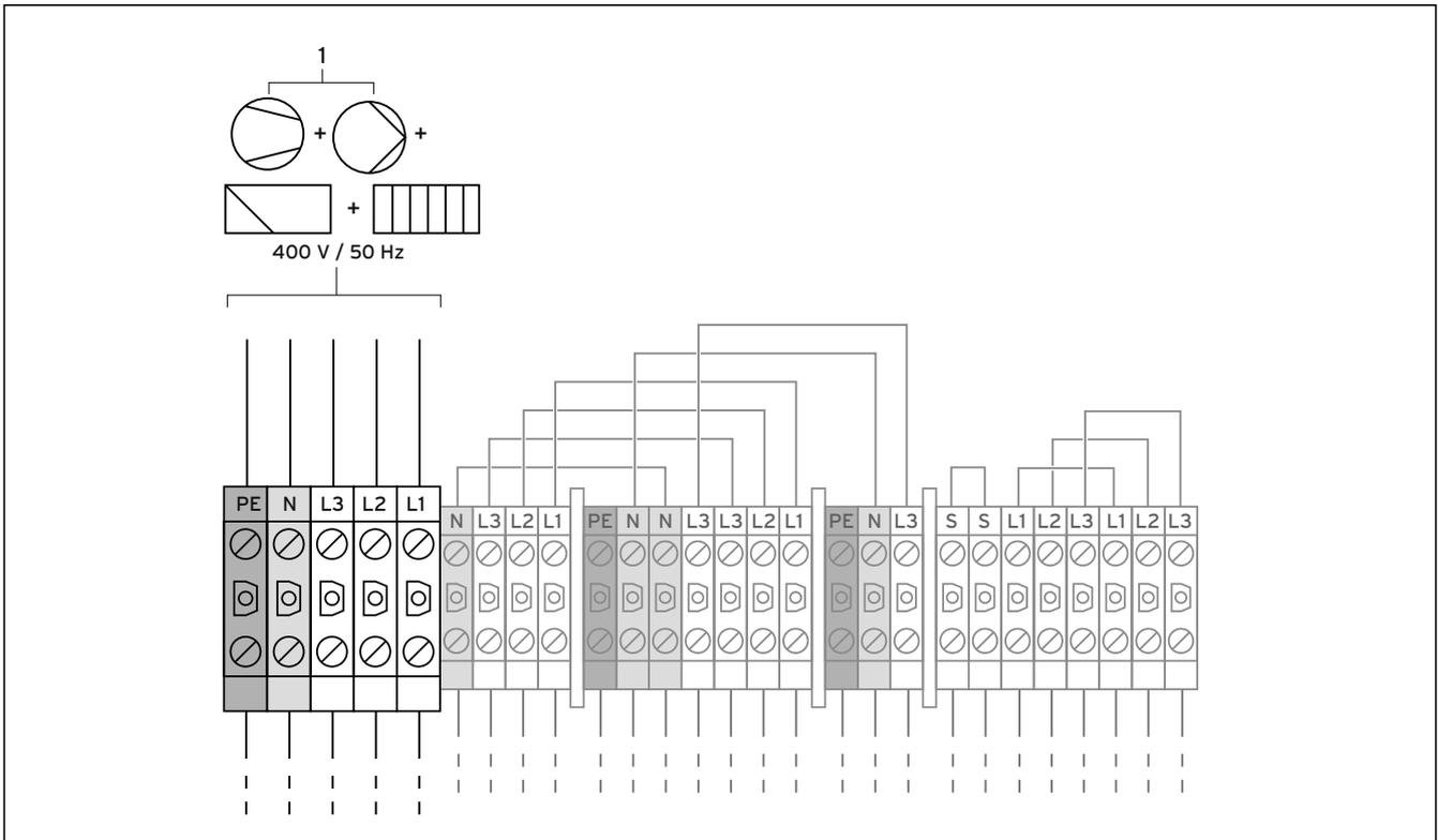
**7.4 Ungesperrte Netzeinspeisung Elektroplan 1 (Lieferzustand)**
