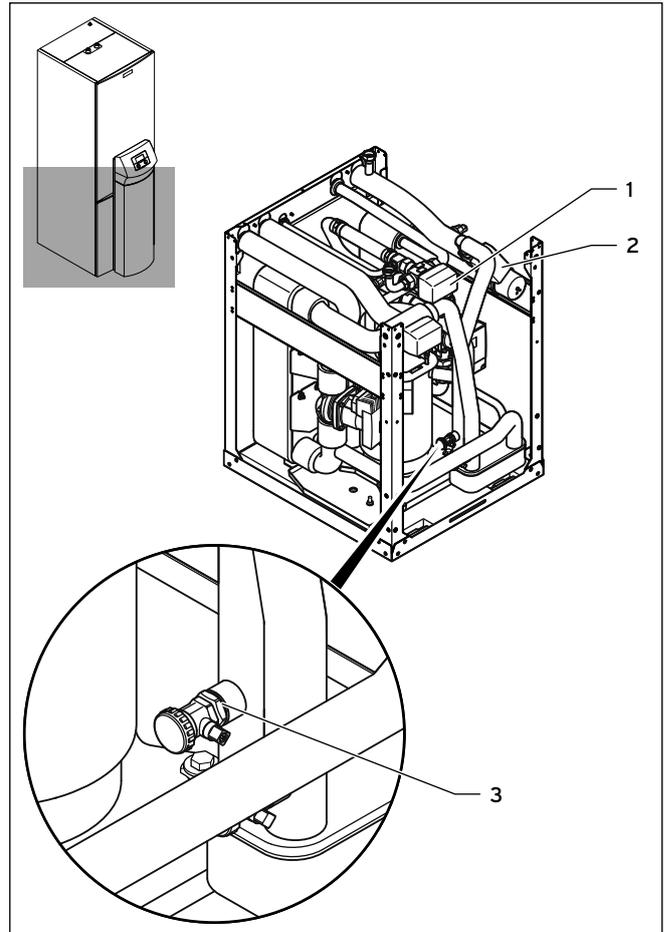
**6.1 Umschaltventile und Füll- und Entleerungsventil des Heizkreises**
