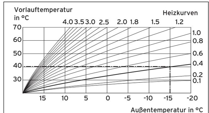
Abb. 1 Diagramm Heizkurven
