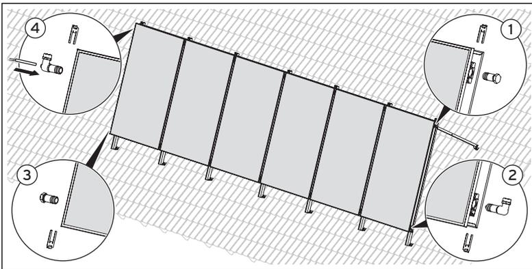
**Abb. 5.25 Hydraulische Anschlüsse montieren (6 oder mehr Flachkollektoren)**
