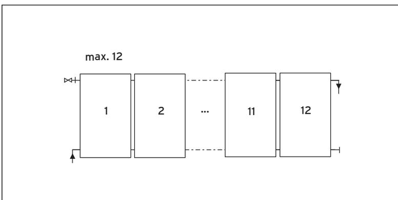
**Abb. 4.3 Reihenschaltung 6 - 12 Flachkollektoren**
