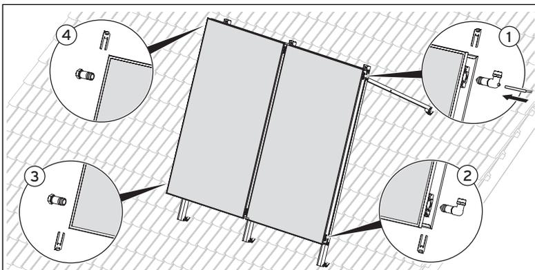
Abb. 5.24 Hydraulische Anschlüsse montieren (1 - 5 Flachkollektoren)
