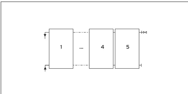
**Abb. 4.2 Reihenschaltung 1 - 5 Flachkollektoren**
