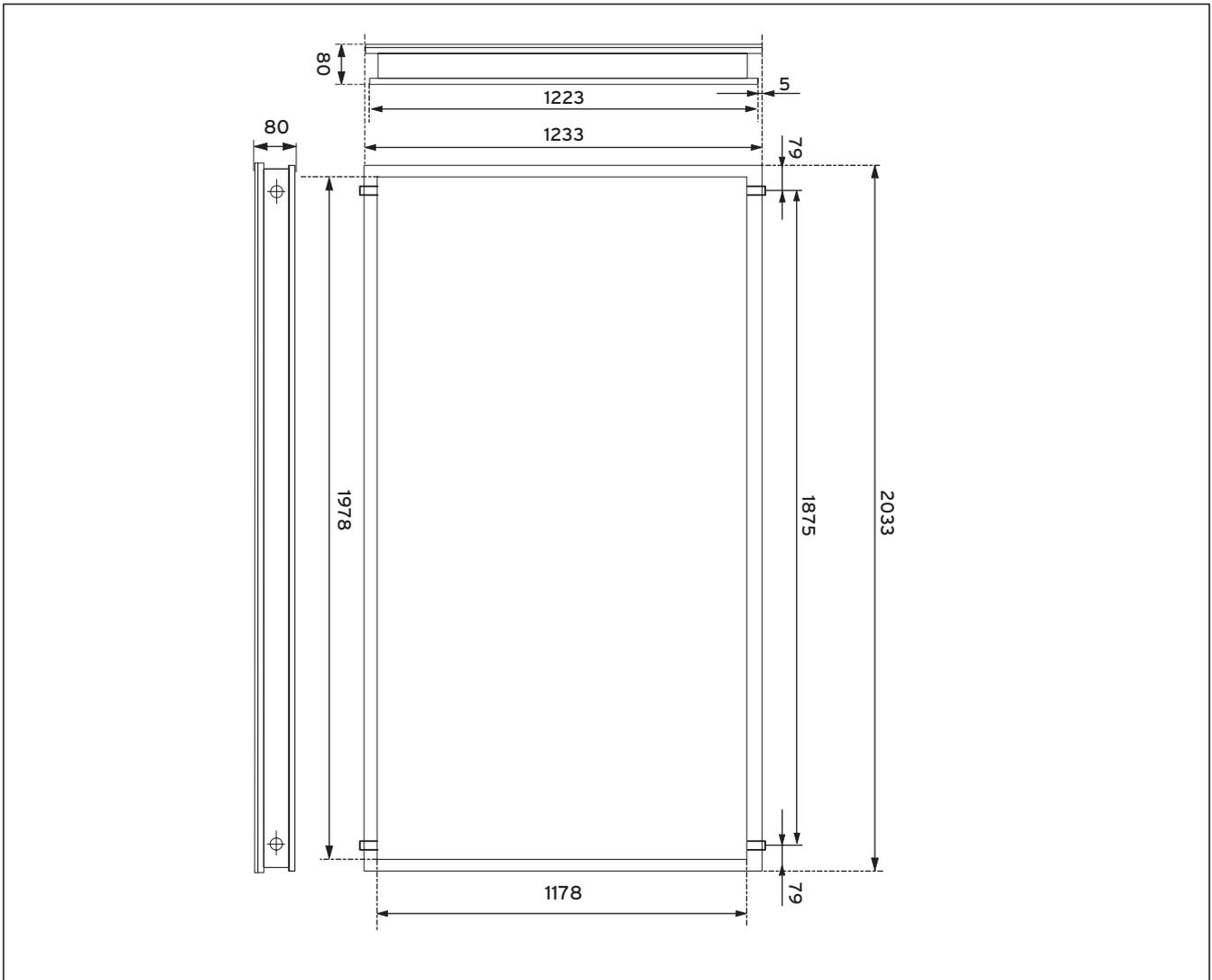
Abb. 12.1 Maßzeichnung VFK 125/2, VFK 145 V, VFK 150 V
