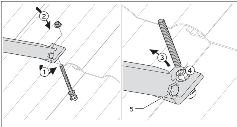
Abb. 5.13 Gestell hinten auf der Stockschraube befestigen
