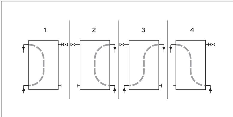
**Abb. 4.1 Durchströmungsrichtung**
