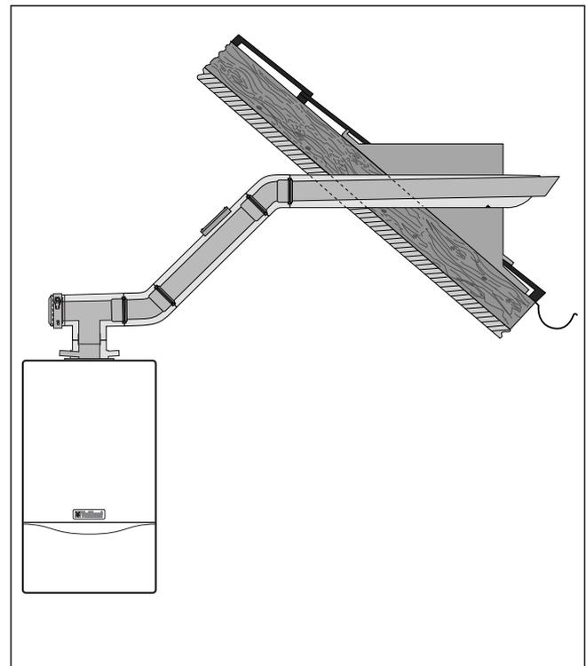
Abb. 4.4 Montagebeispiel: Waagerechte Dachdurchführung
