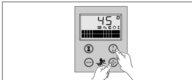
3 Mit den Tasten „+“ oder „-“ stellen Sie jetzt die Pumpenart „4“ ein (= Solarpumpe). Während des Einstellvorgangs blinkt der angezeigte Wert.
