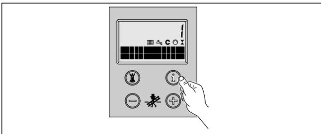
3 Mit den Tasten „+“ oder „-“ können Sie jetzt den Wert erhöhen oder verringern. Um die Pumpenbetriebsart „weiterlaufend“\* einzustellen, geben Sie keinen Zahlenwert ein, sondern wählen mit der Taste „+“ oder „-“ das Symbol „-“ an.
