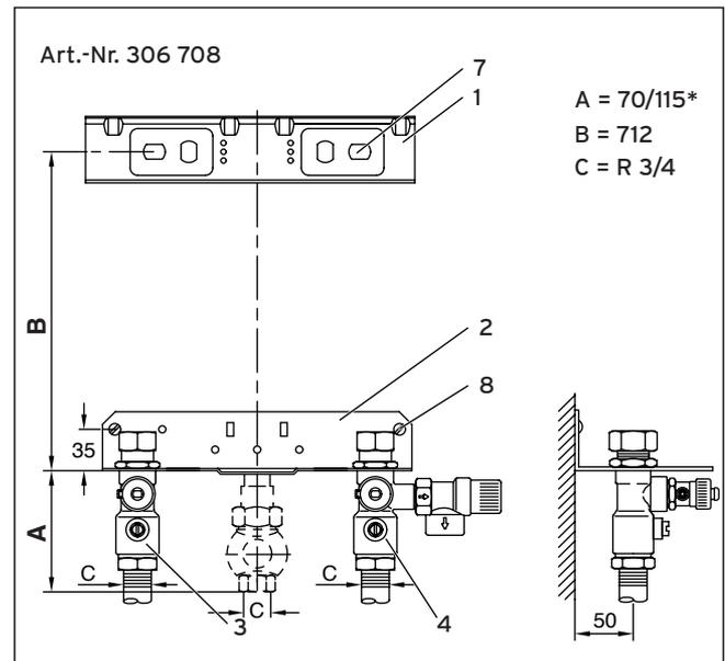
Abb. 3.5 Anschlusskonsole VC (Aufputzinstallation)
