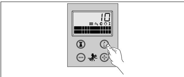
4 Mit den Tasten „+“ oder „-“ können Sie jetzt den Wert in 1-kW-Schritten erhöhen oder verringern. Während des Einstellvorgangs blinkt der angezeigte Wert. Die möglichen Einstellbereiche entnehmen Sie bitte der Tab. 6.1.
