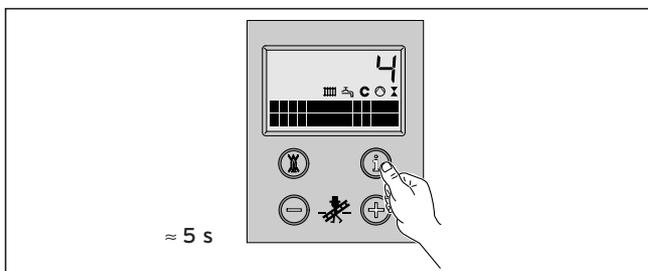
5 In entsprechender Weise nehmen Sie anschließend die Einstellungen vor für die Diagnosepunkte d.73 (= Einschalt-Temperaturdifferenz für Solarpumpe) und d.78 (= Verbrühungsschutztemperatur: Temperatur, bei der die Solarpumpe abgeschaltet wird). Es sind die folgenden Werte einzustellen:
