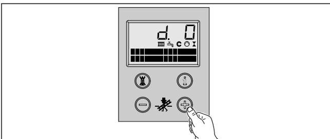
3 Drücken Sie die Taste „i“. Im Display erscheint das Symbol „=“. Anschließend wird die eingestellte Teillast in kW angezeigt.
