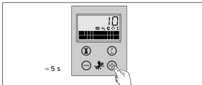
5 Verlassen Sie den Einstellmodus durch gleichzeitiges Drücken der Tasten „i“ und „+“. Im Display erscheint wieder die normale Standard-Anzeige (aktuelle Heizungs-Vorlauftemperatur, z. B. 45 °C). Der Einstellmodus wird auch beendet, wenn Sie 4 Minuten lang keine Taste betätigen.
