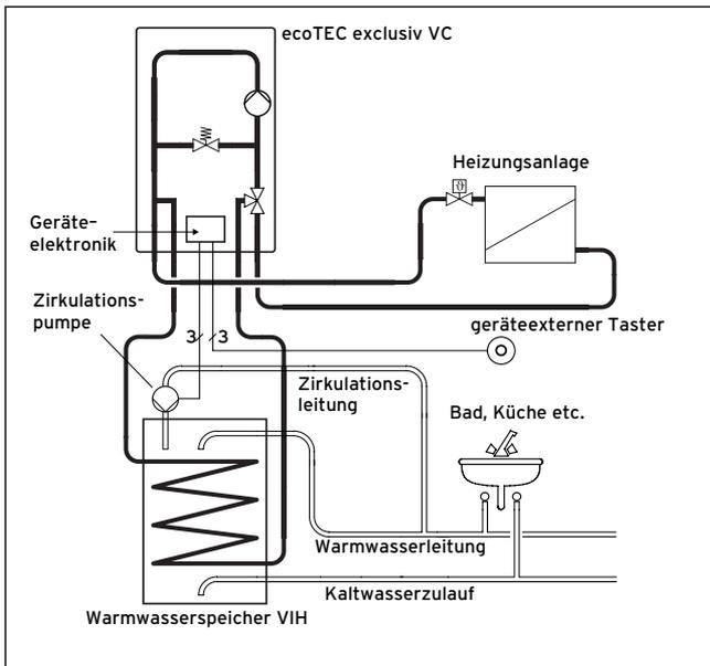
Abb. 4.9 Bedarfsabhängige Ansteuerung einer Zirkulationspumpe
