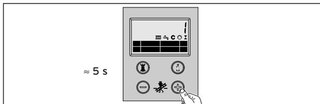
5 Verlassen Sie den Einstellmodus durch gleichzeitiges Drücken der Tasten „i“ und „+“. Im Display erscheint wieder die normale Standard-Anzeige (aktuelle Heizungs-Vorlauftemperatur, z. B. 45 °C). Der Einstellmodus wird auch beendet, wenn Sie 4 Minuten lang keine Taste betätigen.
