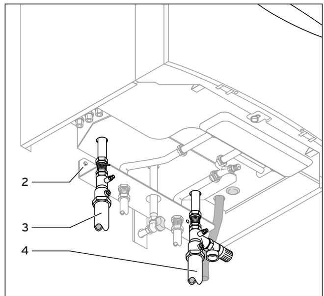
Abb. 4.2 Heizungs- vorlauf und Heizungs- rücklauf montieren
