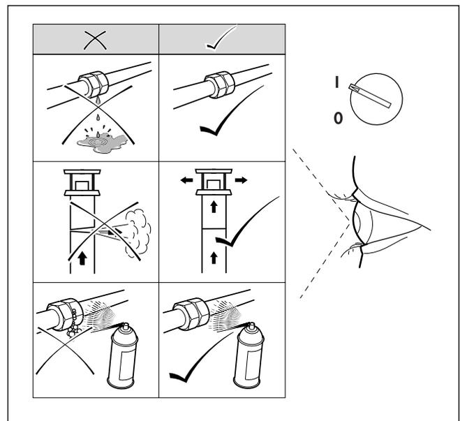
Abb. 5.5 Funktionsprüfung
