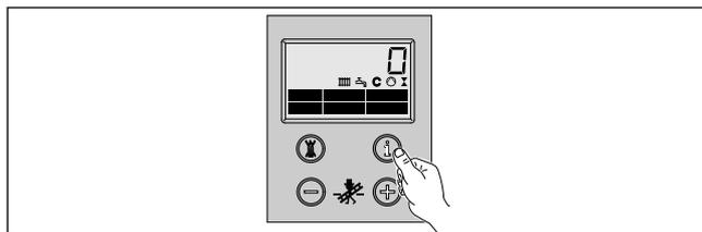
3 Mit den Tasten „+“ oder „-“ können Sie jetzt statt der automatischen Drehzahlregelung einen Festwert von 53, 60, 70, 85 oder 100 % der max. möglichen Pumpenleistung einstellen. Während des Einstellvorgangs blinkt der angezeigte Wert.
