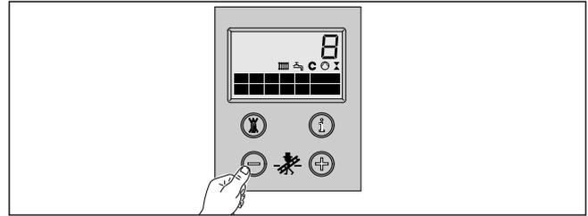
5 Halten Sie anschließend die Taste „i“ für ca. 5 s gedrückt bis die Anzeige nicht mehr blinkt. Der Wert ist nun gespeichert.
