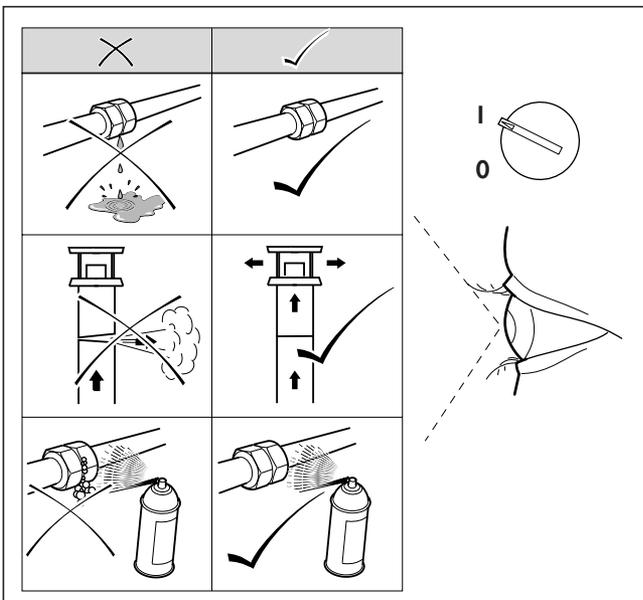
Abb. 8.10 Funktionsprüfung
