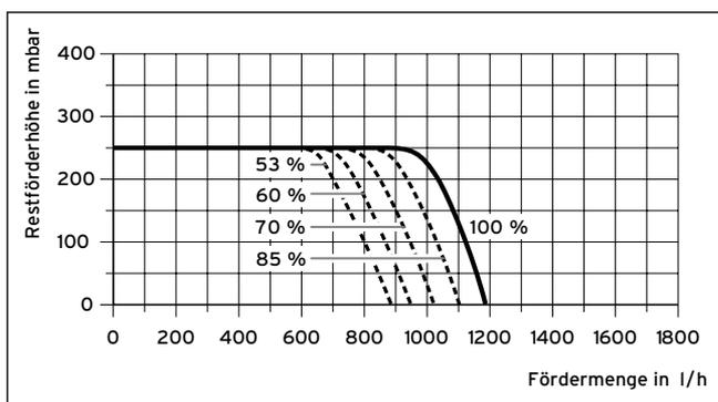
Abb. 6.3 Pumpenkennlinie ecoTEC exclusiv VC 136, 206, 276
