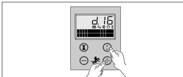
Abb. 6.8 ff Einstellungen bei Anschluss von Solaranlagen
