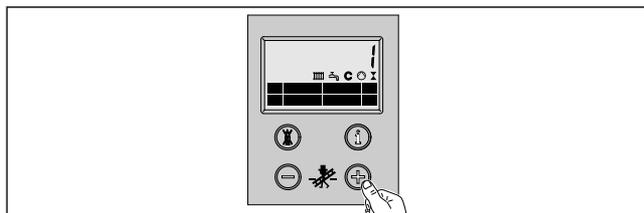
4 Halten Sie die Taste „i“ für ca. 5 s gedrückt, bis die Anzeige nicht mehr blinkt. Der eingestellte Wert ist nun gespeichert.
