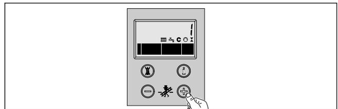
4 Halten Sie die Taste „i“ für ca. 5 s gedrückt, bis die Anzeige nicht mehr blinkt. Der eingestellte Wert ist nun gespeichert.
