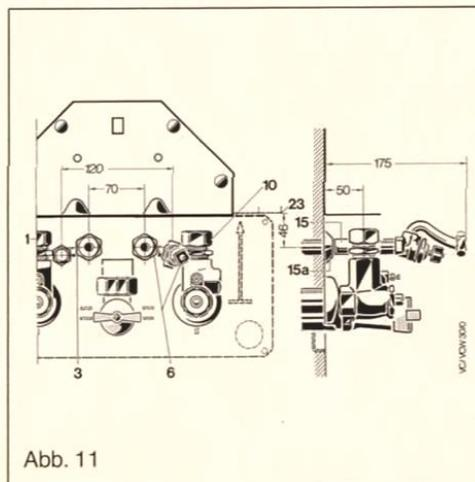
a) Kaltwasseranschluß mit Absperrventil (6) in Kaltwasserleitung (rechts) und Warmwasseranschluß (3) in Warmwasserleitung unter Verwendung der Verlängerungsstücke (15) und der Rosetten (15a) auf 175 mm Wandabstand dicht einschrauben. (Bei Überputzinstallation werden die Verlängerungsstücke (15) nicht benötigt.)
