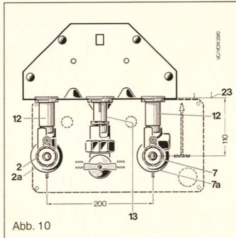
a) Wartungshähne (2 u. 7) mit 50 mm Wandabstand unter Verwendung der zugehörigen Rosetten (2a u. 7a) dicht in Heizungsvorlauf- (links) und -rücklaufleitung (rechts) einschrauben. Wartungshahn mit zusätzlichem seitlichem Anschluß (7) in Rücklaufleitung. Die richtige Lage der Wartungshähne ist durch die Distanzstücke „Heizung“ (12) der Anschlußkonsole gegeben.
