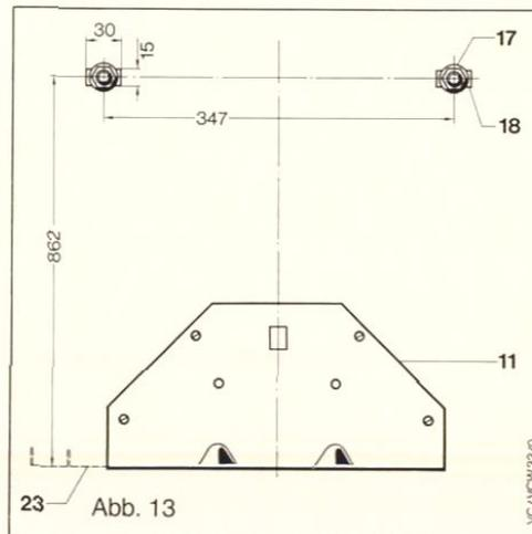
a) Zwei Haken, Gewindebolzen oder Maueranker (17) für die Aufhängeöffnungen (18) des Gerätes in der Wand befestigen.
