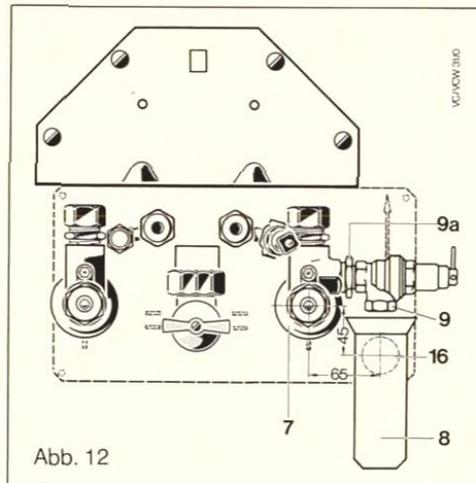
a) Der Einbau erfolgt unter Verwendung des dem Sicherheitsventil (9) beiliegenden Reduzierstückes R 3/4" - R 1/2" (9a) am seitlichen Anschluß des Wartungshahnes im Heizungsrücklauf (7). Reduzierstück und Sicherheitsventil sind dicht einzuschrauben.
