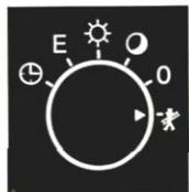
Diese Betriebsart ist nur für Einstellarbeiten und Messungen an der Heizungsanlage vorgesehen. Die Heizungsregelung ist hierbei ausgeschaltet.
