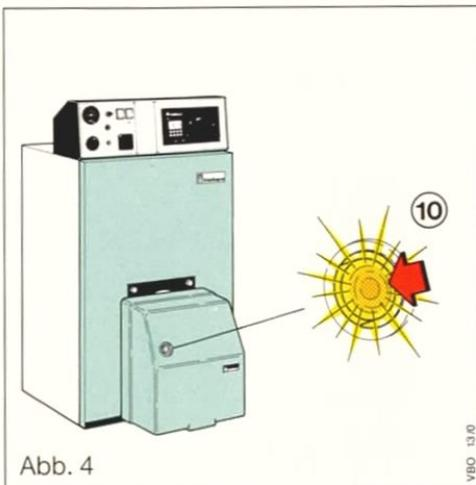
Wurde der automatische Brennerstart durch den Feuerungsautomaten unterbrochen.
