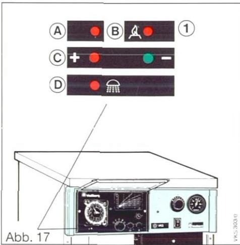
Ⓐ **rote** Betriebslampe brennt: es wird mehr Wärme angefordert; der Brenner ist in Betrieb.
