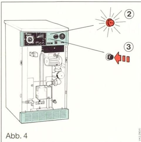
– Erfolgt keine automatische Zündung, leuchtet die Störmeldelampe auf. (Eine Funktionskontrolle des Brenners kann auch durch die Brennersichtöffnung vorgenommen werden.)
