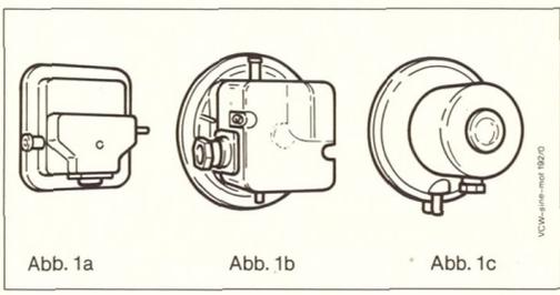
Ist am Gerät eine dieser 3 Druckwächterausführungen montiert, so werden beim Austausch die Befestigungsplatte, die zwei Schläuche und das 2-adrige Anschlusskabel, welche lose beige packt sind, nicht benötigt.
