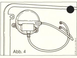
Befestigungsplatte (1) gemäß Abb. 5a, b bzw. c rückseitig am Druckwächter anschrauben, in die Aufnahmebuchse in der Geräterückwand einstecken und mit der Schraube (2) befestigen. Schläuche (3 u. 4) an den Anschlüssen von Gerät und Druckwächter gemäß Abb. 5a, b bzw. c aufstecken.
