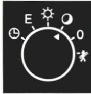
Die Heizungsregelung arbeitet ständig — ohne Berücksichtigung der Schaltuhr — nach der auf «Temperaturabsenkung» eingestellten niedrigeren Heizkurve. Es stellt sich die gewünschte niedrigere Raumtemperatur ein.
