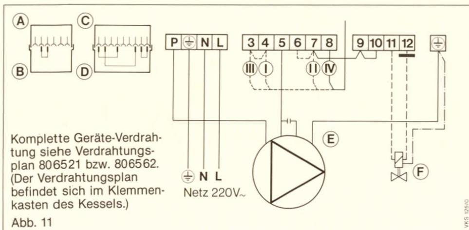
Zur Überwachung der maximal zulässigen Temperatur in einem Fußbodenheizkreis ist zusätzlich ein Anlegethermostat VRC 9642 mit der zugehörigen Heizungspumpe in Reihe zu schalten.
