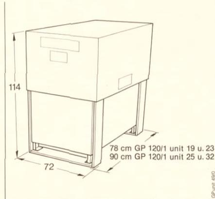
1 Kesselblock mit beigelegtem Flammenleitteil, (nur bei unit 19 u. unit 23) komplett zusammengebaut und verdrahtet mit automatischem Öl-Gebläse-brenner, Heizungspumpe, Manometer, Ausdehnungsgefäß, Entleerungshahn, Sicherheitsventil, Schnellentlüfter, Kesselverkleidung mit integrierter Schaltleiste mit beigelegtem Heizungsregelungs-Set.
