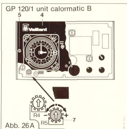
Die Vorlauftemperatur Minimalbegrenzung muß auf 38°C eingestellt werden. Der Anwendungsbereich der Vorlauf-temperatur Minimalbegrenzung erstreckt sich auf Heizungsanlagen mit Brennersteuerung, in denen ein zuverlässiger Schutz des Heizkessels gegen Niedertemperaturkorrosion eingehalten werden soll.
