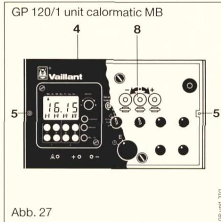
Die eingestellte Taktzeit ist abgestimmt auf Vaillant Mischermotor VRM 646. Die Taktzeit kann durch Drehen am Einstellknopf (8) nach links – langsamer, nach rechts – schneller gestellt werden.
