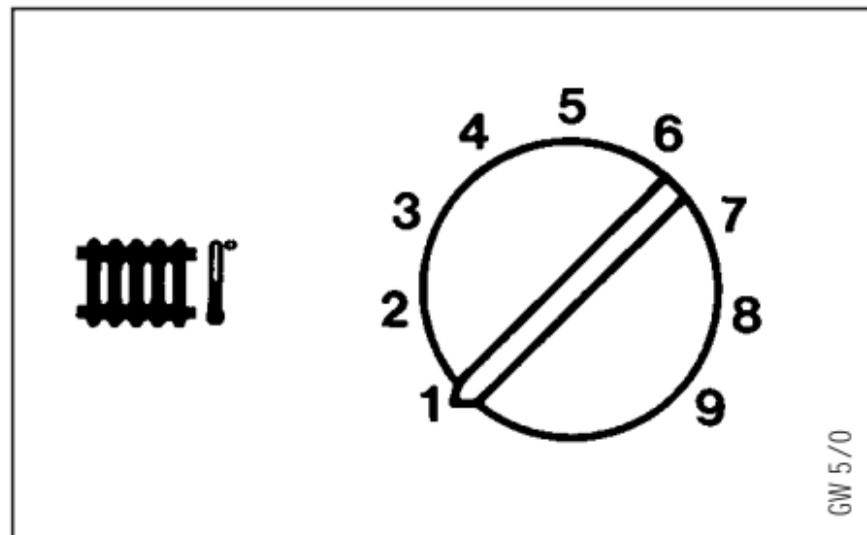
Normalerweise läßt sich der Vorlauftemperatur-Regler stufenlos im Bereich von 1 - 7 bis zu einer Vorlauftemperatur von max. 75°C einstellen.
