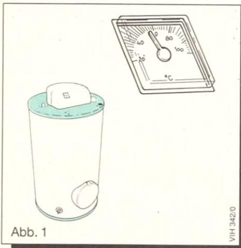
Vor dem ersten Aufheizen stets eine Zapfstelle öffnen, um zu prüfen, ob der Behälter auch mit Wasser gefüllt ist und die Absperrvorrichtung in der Kaltwasserzuleitung nicht geschlossen ist.
