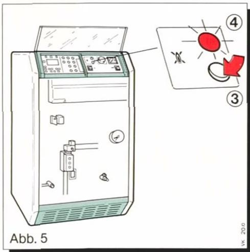
– Erfolgt keine automatische Zündung, leuchtet die Störmeldelampe auf. (Eine Funktionskontrolle des Brenners kann auch durch die Brennersichtfenster vorgenommen werden).
