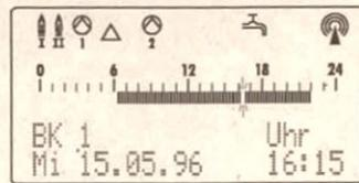
Wenn Basis Display sichtbar, drücken Sie die Taste
