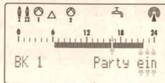
Wenn Basis Display sichtbar, drücken Sie die Taste bis der Heizkreis angezeigt wird, für den Sie die Party-Funktion einschalten möchten, z.B. BK 1. Drücken Sie die Taste so oft bis „Party aus“ angezeigt
