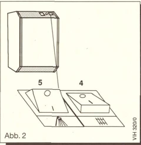
**⚠ Die Ablaseleitung des am Wassererwärmer angebrachten Sicherheitsventiles muß stets offen bleiben.**
